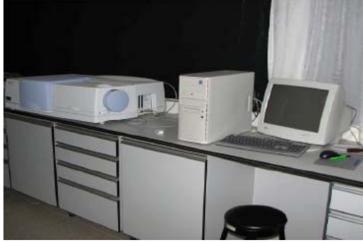
Şekil 5.1 Celal Bayar Üniversitesi Lüminesans Araştırma Laboratuvarında bulunan Perkin Elmer Lambda 950 UV/VIS/NIR Spektrofotometre Sistemi
