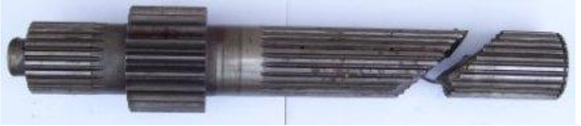
Şekil 2.4 Hasarlı Şanzıman Grup Mili
