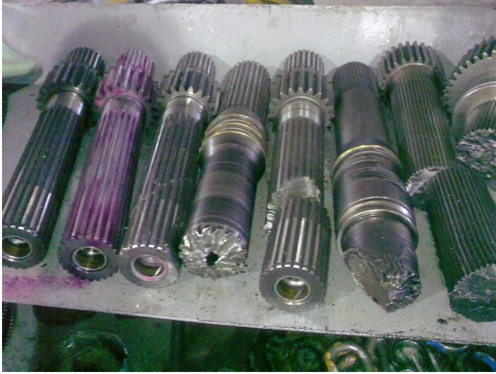
Şekil 2.5 Hasarlı Şanzıman Grup Milleri
