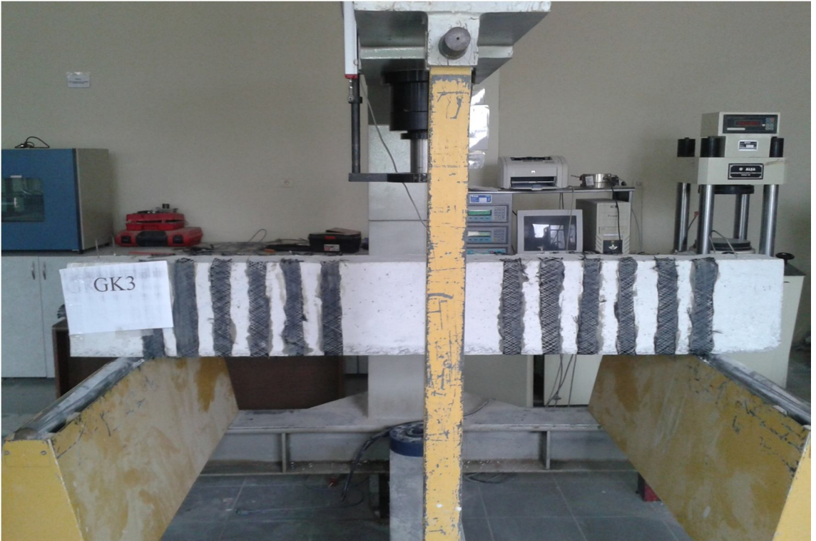
Şekil 6.10. GK3 kirişinin Karbon takviyeli kumaş lifleriyle sarılıp güçlendirilmesi
