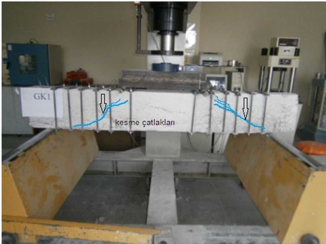
Şekil 8.5. GK1 kirişinde göçme sonucu oluşan kesme çatlakları
