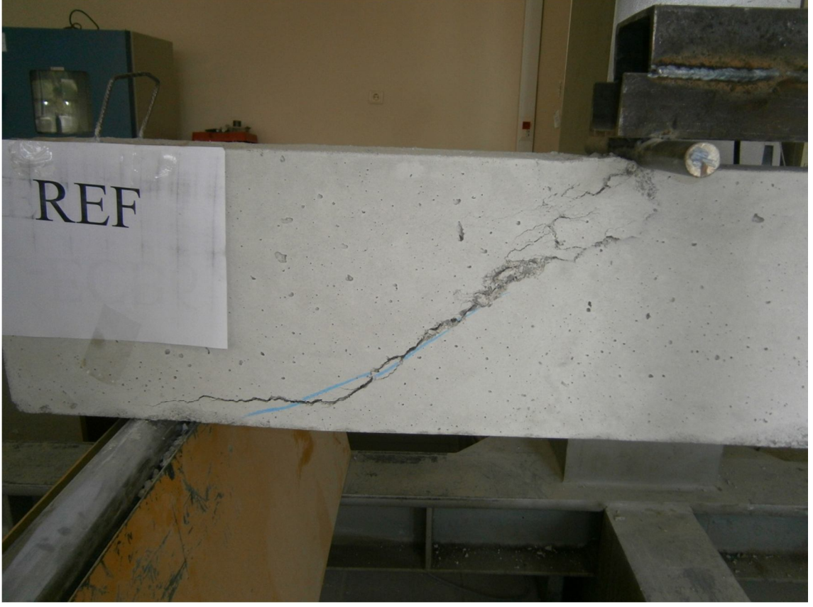
Şekil 8.3. Referans kirişte göçme sonucu oluşan kesme çatlakları
