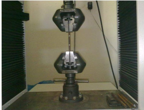
Şekil 3.3. Çekme Deneyine Tabi Tutulan Donatı
