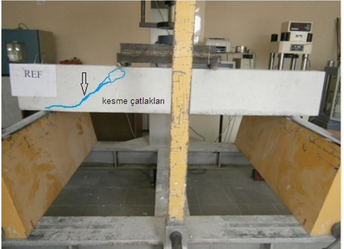
Şekil 8.2. Referans kirişte göçme sonucu oluşan kesme çatlakları
