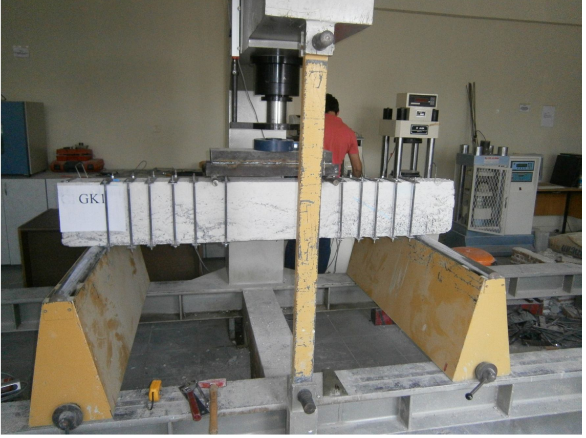
Şekil 6.4. GK1 kirişinin dış donatılar ile sarılarak güçlendirilmesi
