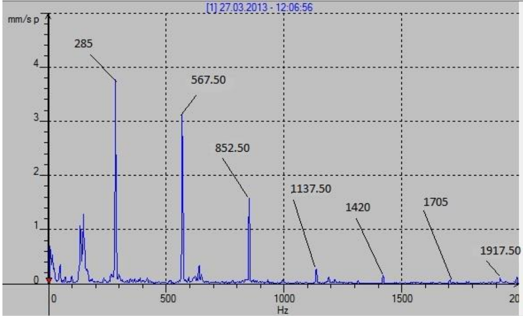
Şekil 9.39. Bir numaralı kompresör birinci yatak titreşim spektrum grafiği ( 27.03.2013, 2000 Hz )
