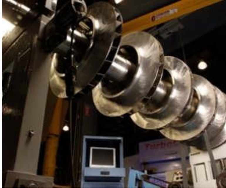
Şekil 7.1.Santrifüj kompresör fanı
