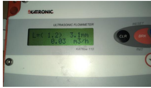
Şekil 3.4 Debi Ölçümleri İçin Kullanılan KATFLOW 110 Serisi Ultrasonik Debimetre
