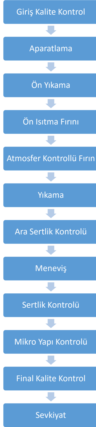
Şekil 2.3 Batı Isıl İşlem Sementasyon Süreci İş Akış Adımları [23]
