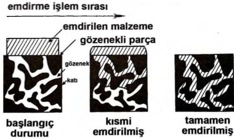
Şekil 2.28. Emdirme Sinterleme [6]
