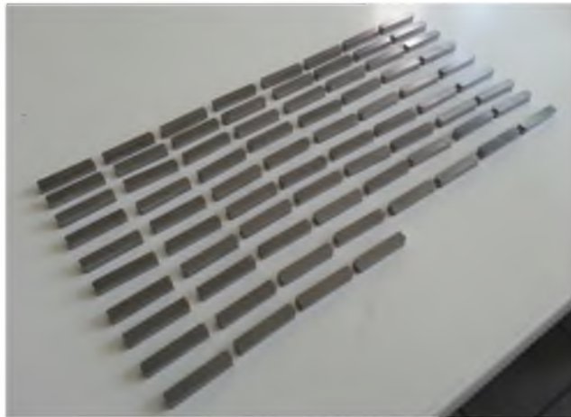
Şekil 3.3. Saf demir tozundan preslenen numunelerin presleme sonrası görüntüsü
