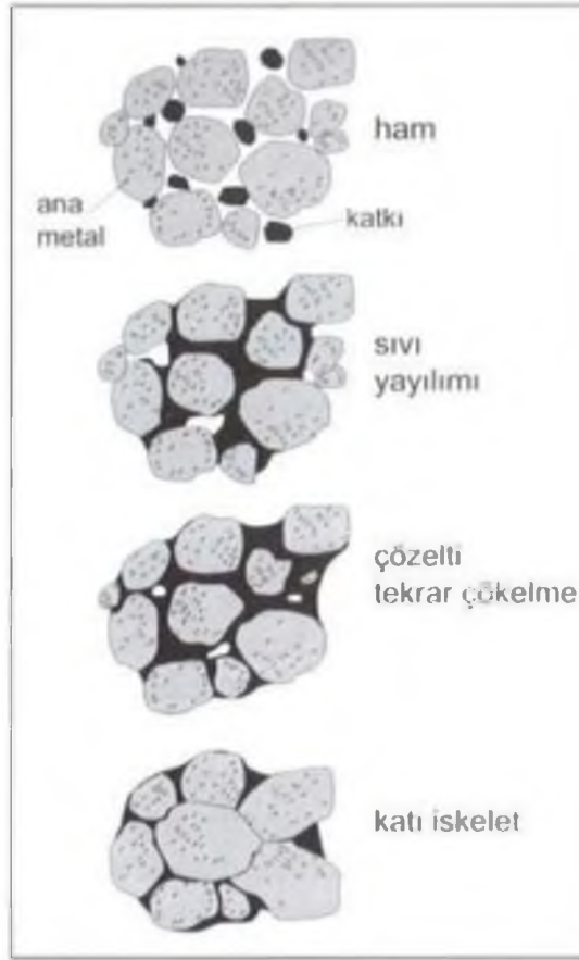
Şekil 2.20. Sıvı faz sinterlemenin kavramsal aşamaları [1]
