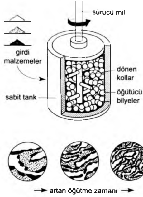
Şekil 2.5. Mekanik alaşımlama [1]
