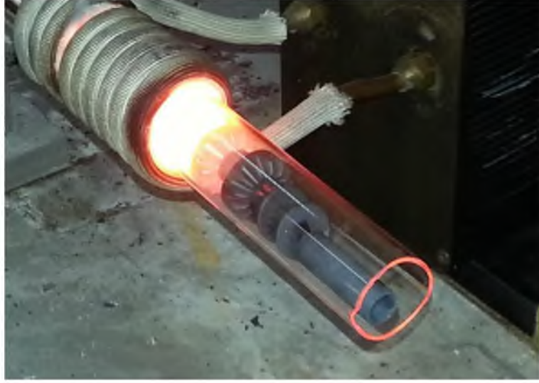
Şekil 3.16. Çeşitli şekil ve boyutlardaki numunelerinin indüksiyon ile sinterlenmesi
