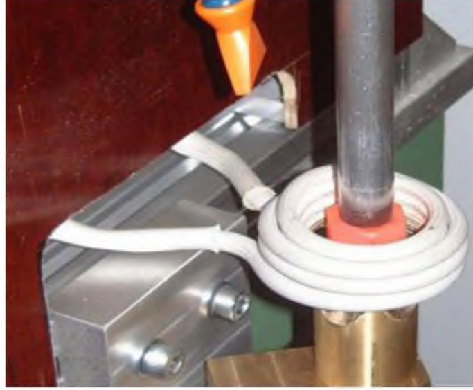
Şekil 2.36. İndüksiyon ile ısıtma ile sıkı geçme [79]
