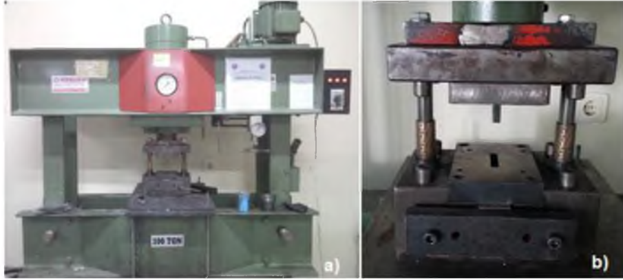
Şekil 3.2. a) 100 tonluk hidrolik pres, b) Kalıp
