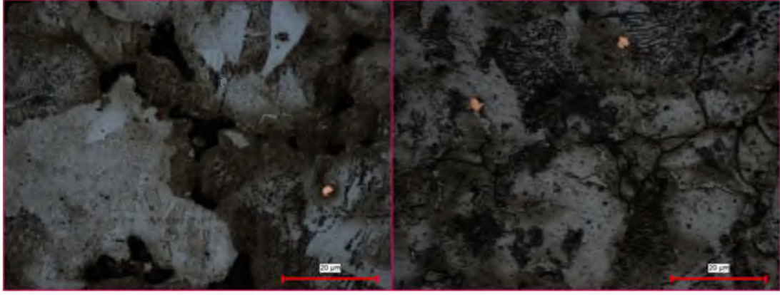
Şekil 4.77. İndüksiyon ile ve fırında ve ön sinterlemesiz olarak sinterlenen % 3 Cu, % 0,5 grafit içerikli demir numunelerin mikro yapı görüntüleri a) İndüksiyon ile 15 dakika sinterlenen numune b) Fırında 30 dakika sinterlenen numune
