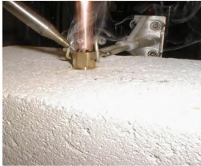
Şekil 2.37. İndüksiyon ile kaynak [79]
