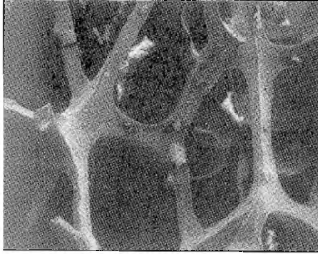
Şekil 2.21. Sıvı faz sinterleme sonucu oluşan yapı [1]
