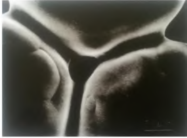
Şekil 2.13. Sinterlemede boyun oluşumu [6]
