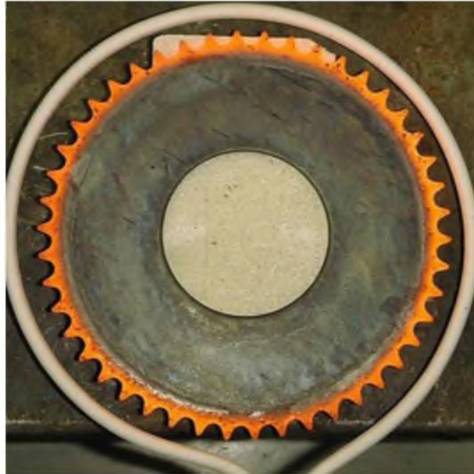
Şekil 2.35. İndüksiyon ile dişli çark sertleştirme [79]
