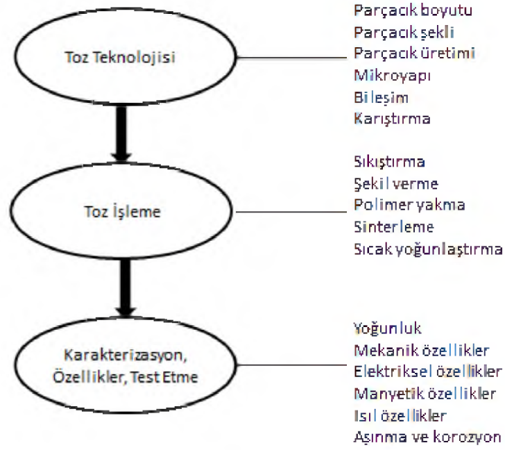
Şekil 2.3. Toz metalurjisi işlem adımları [1]
