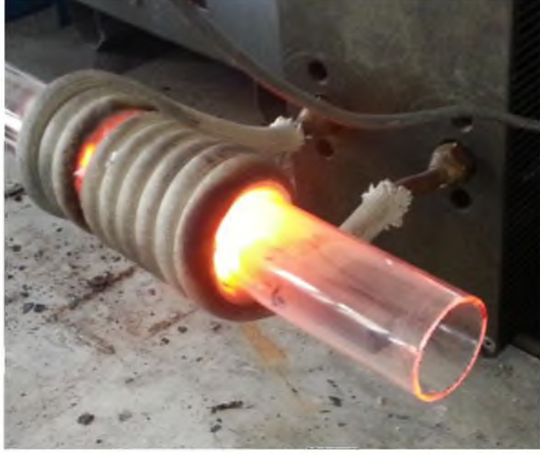
Şekil 3.15. 10x10x 55 mm deney numunelerinin indüksiyon ile sinterlenmesi
