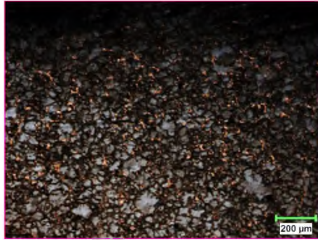
Şekil 4.100. Demir tozunun üzerine bakır tozunun preslenmesiyle oluşan numunenin indüksiyon ile sinterleme sonrası mikro yapı görüntüsü
