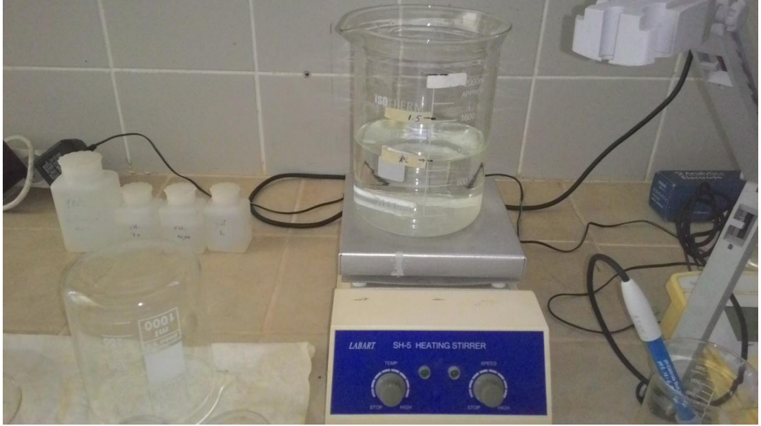
Şekil 3.15. Isıtmalı karıştırıcı (Labart SH-5)
