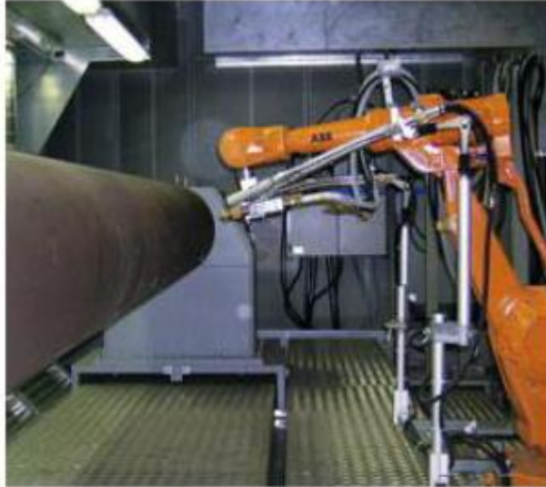
Şekil 2.7. Robot teknolojisiyle plazma sprej işlemi [34].
