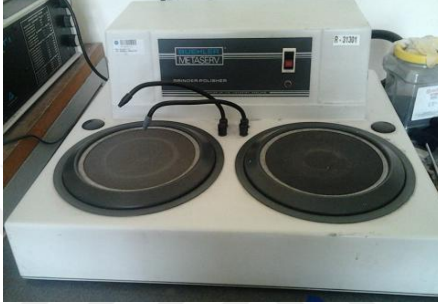
Şekil 3.1. Zımparalama ve parlatma cihazı (Buehler-Metaserv R-31301)
