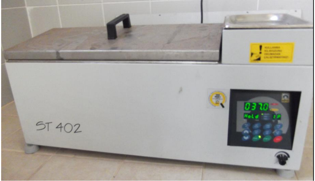
Şekil 3.13. Çalkalamalı ve ısıtmalı su banyosu (Nüve St-402)
