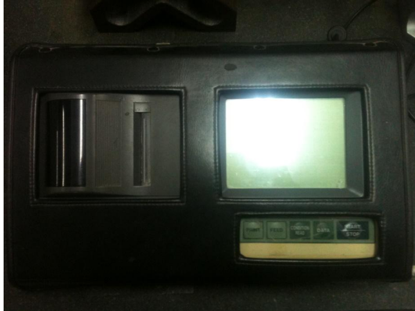
Şekil 3.18. Yüzey pürüzlülük ölçüm cihazı (Mitutoyo Surflest SJ-301)
