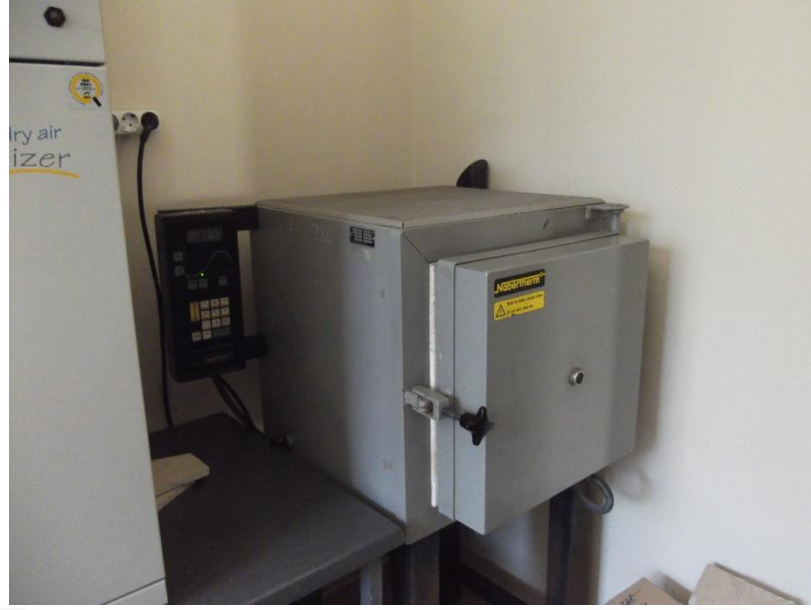
Şekil 3.8. Isıl işlem fırını (Nabertherm N50)
