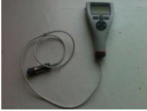
Şekil 3.17. Dijital kaplama kalınlığı ölçüm cihazı (ElektroPhysik Minitest 730/Sensor FN 1,5 HD)
