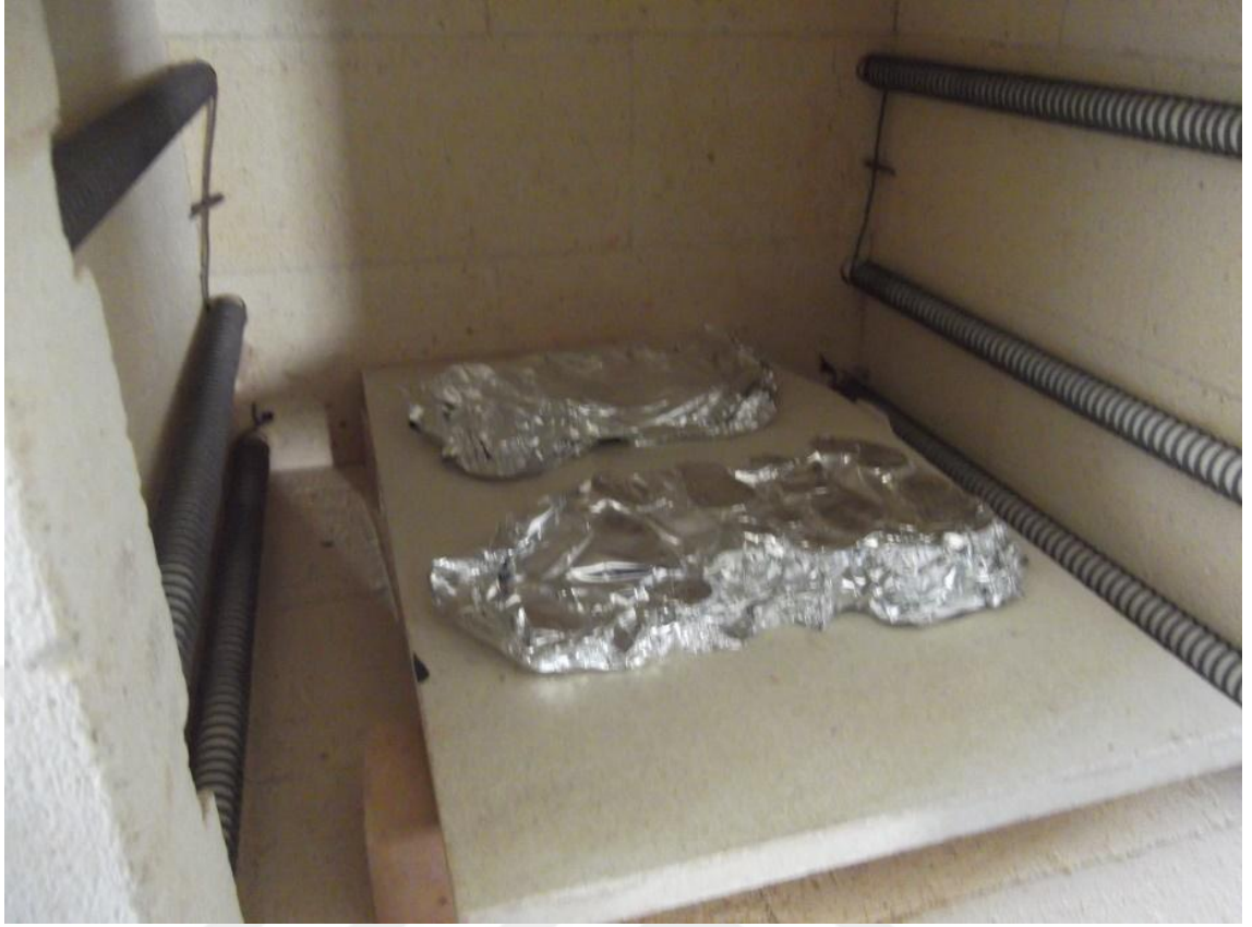
Şekil 3.7. Isıl işlem için alüminyum folyoya sarılmış altlıklar
