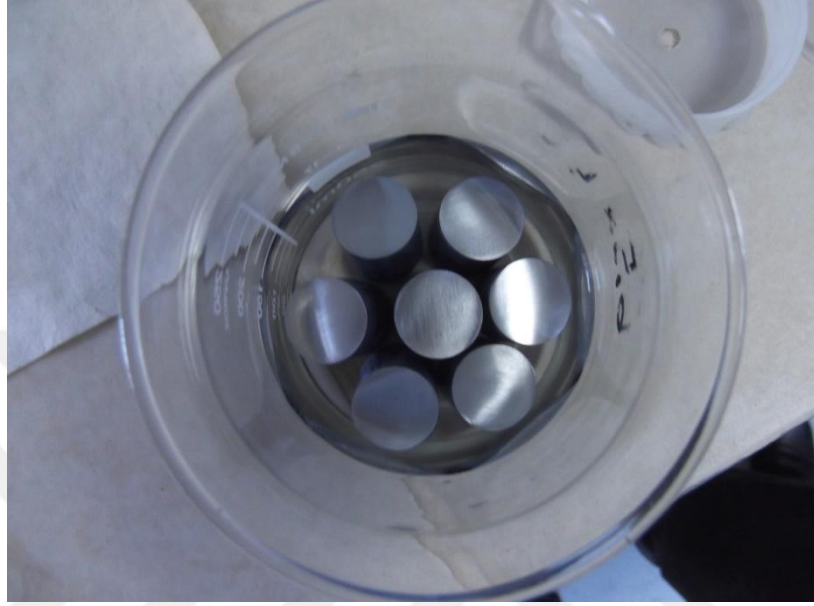
Şekil 3.3. Aseton içerisindeki malzemeler
