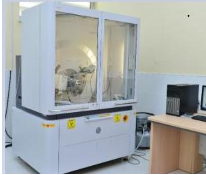
Şekil 3.22. PANalytical Empyrean model XRD ölçüm cihazı
