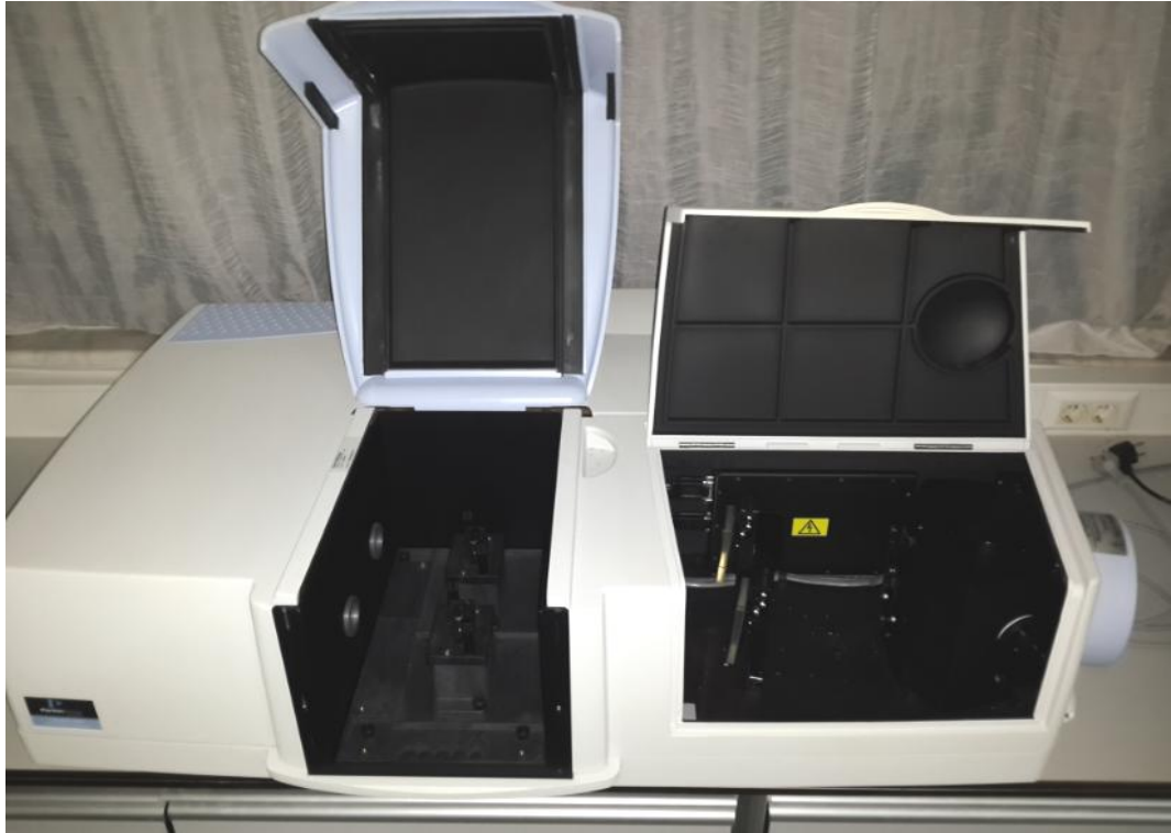
Şekil 3.17. İki farklı tür (sıvı-katı) örnek odası mevcut olan Lambda 950 Spektrofotometresi
