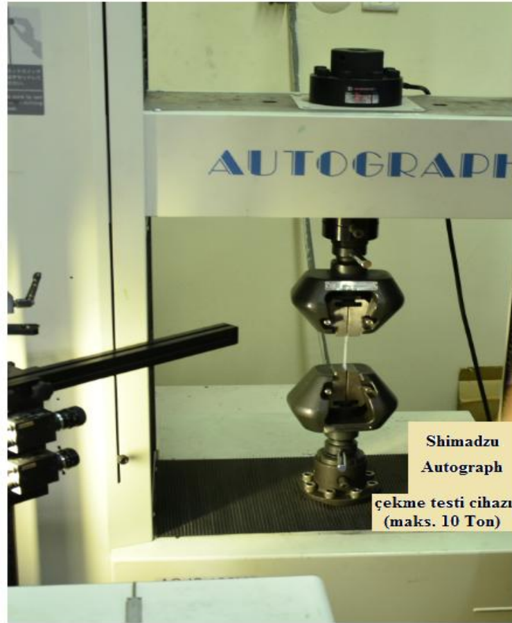
Şekil 3.18. Çekme testleri için kullandığımız Shimadzu Çekme, Basma ve Üç Nokta Eğme Cihazı
