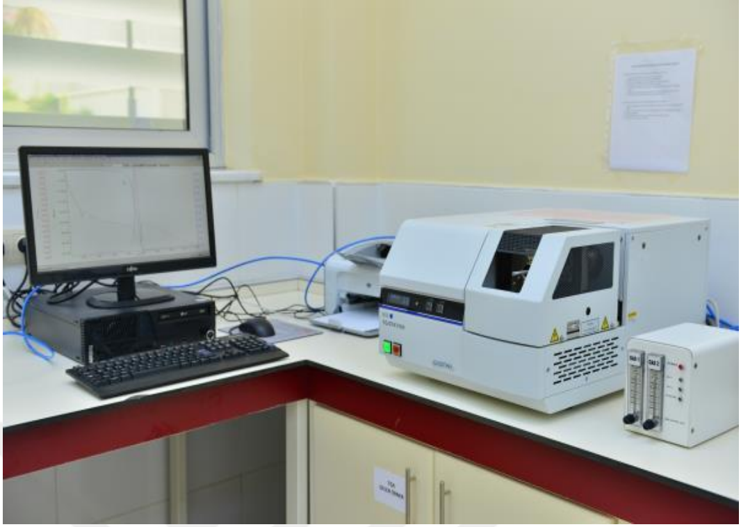
Şekil 3.21. TG-DTA analizleri için kullanılan Hitachi SII Exstar 7300 marka deney cihazı [99]
