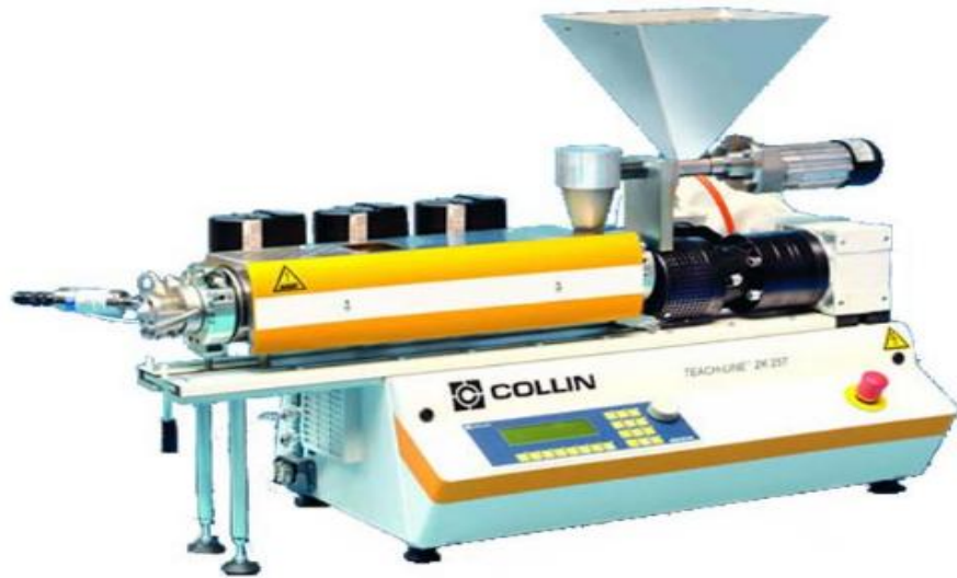
Şekil 3.8. Collin ZK 25T tezgah tipi çift vidalı karıştırıcı resmi [87]
