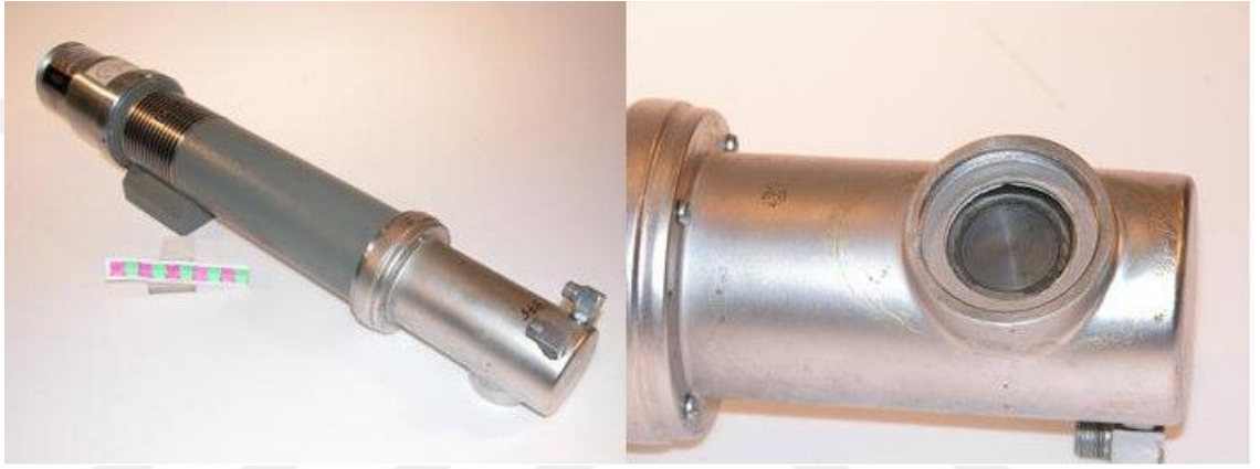
Şekil 3.12. Işınlama amacıyla kullanılan X-ışını tüpü
