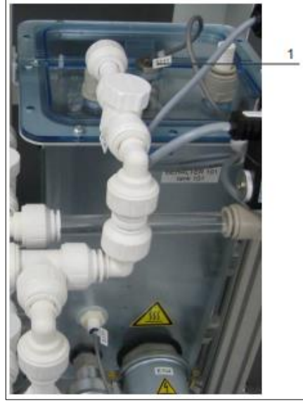
Şekil 5.4. Taşma güvenliği için şamandıra anahtarı (1) ile seviye takibi
