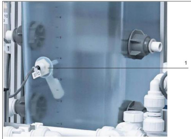
Şekil 5.5. Eşik işlev için şamandıra anahtarı S112(1) ile seviye izleme
