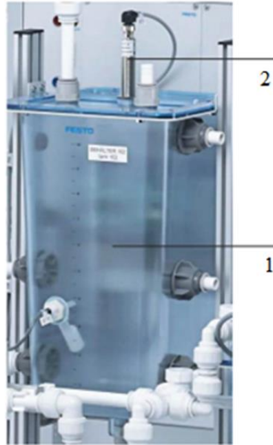
Şekil 5.8. Seviye kontrol sistemi – B102 tankı (1) ve ultrasonik sensör B101(2)
