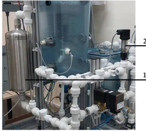
Şekil 5.12. Kontrol edilen basınç sistemi. Oransal valf V106 (1) ve piezorezistif basınç sensörü B102(2)
