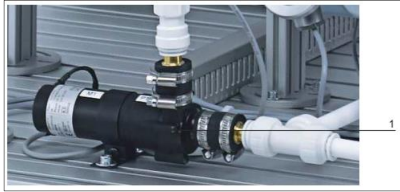
Şekil 5.6. Kontrol elemanı – Pompa P101 (1)
