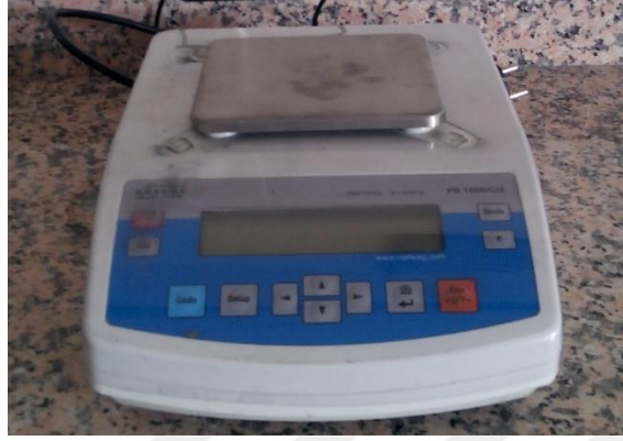
Şekil 4.13. Radwag PS 100-c-2 hassas tartı
