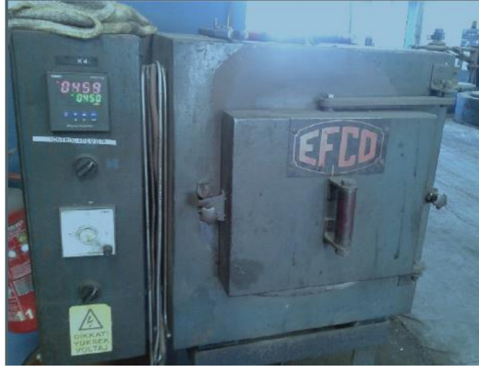
Şekil 4.2. EFCO Elektrikli laboratuvar fırını
