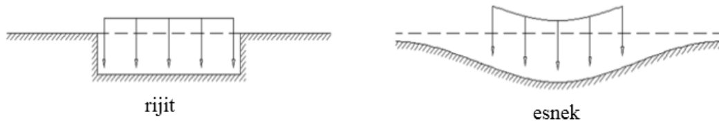
Şekil 2.2. Gerçek hayattaki zemin ve Winkler temelinde oluşacak olan deplasmanın şekli (b) [35]
