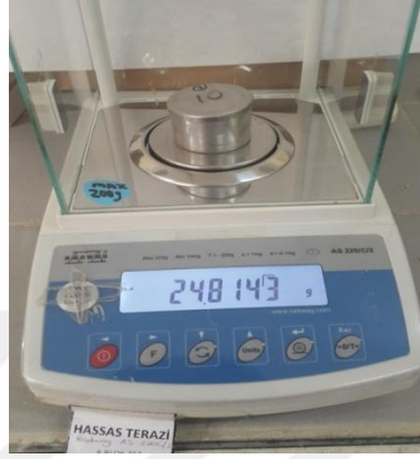
Şekil 3.7. Filtre kâğıdının alüminyum kutuya yerleştirilerek hassas tartı ile tartılması
