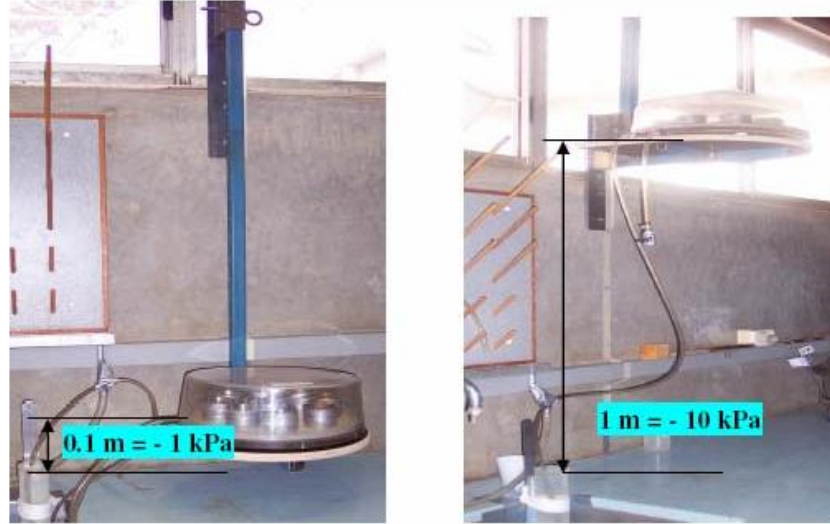
Şekil 2.5. Zemin örneklerinin 1 kPa ve 10 kPa'lık emme basıncı değerlerinde dengelenmesi
