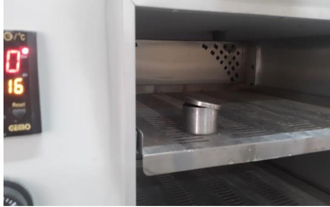
Şekil 3.8. Filtre kâğıdının alüminyum kutuya yerleştirilerek etüvde bekletilmesi
