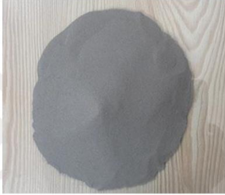
Şekil 5.1. Çalışmada kullanılan % 99 safliktaki alüminyum tozu
