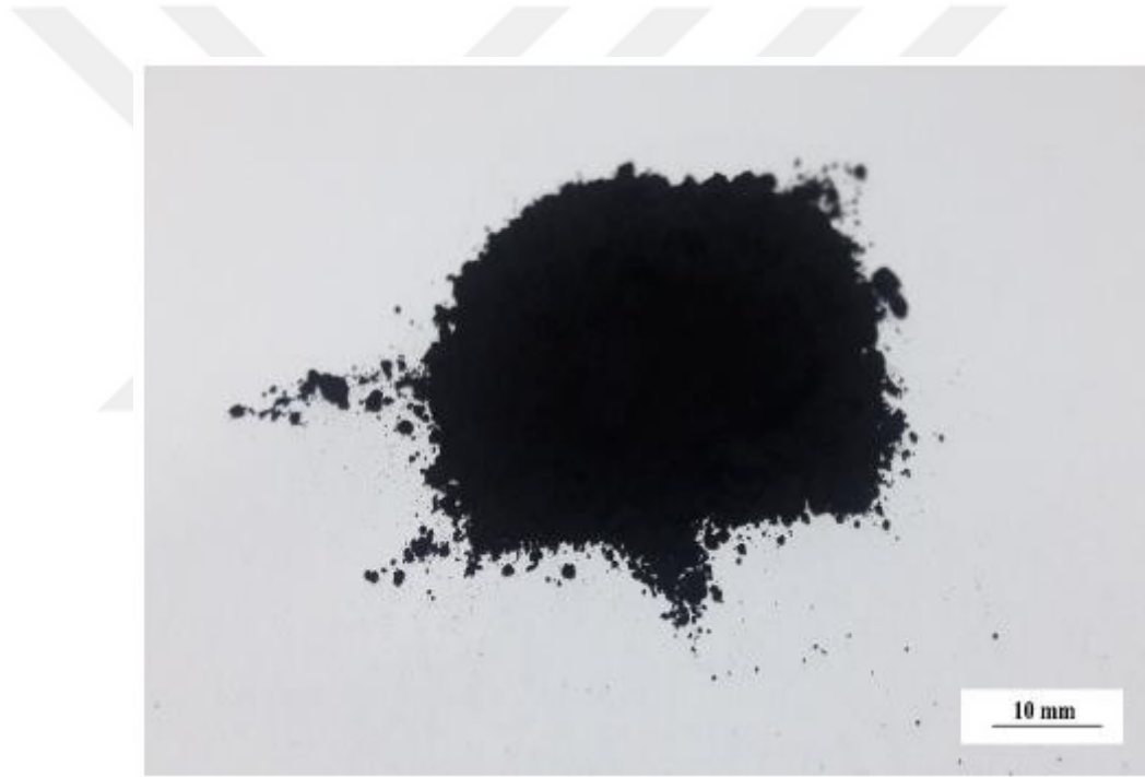
Şekil 5.2. Çalışmalarda kullanılan grafen tozu
