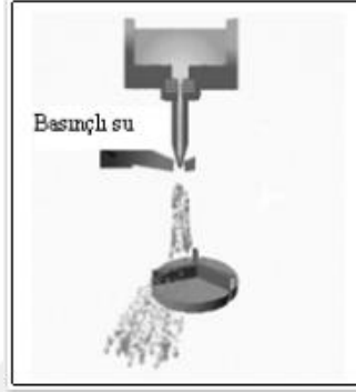
Şekil 2.14. Döner disk atomizasyon yöntemi [24]
