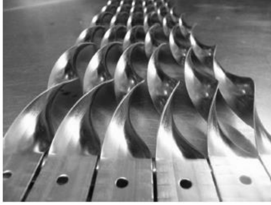
Şekil 15. Isı transfer oranını arttırmayı sağlayan bükülmüş bantlar [34]
