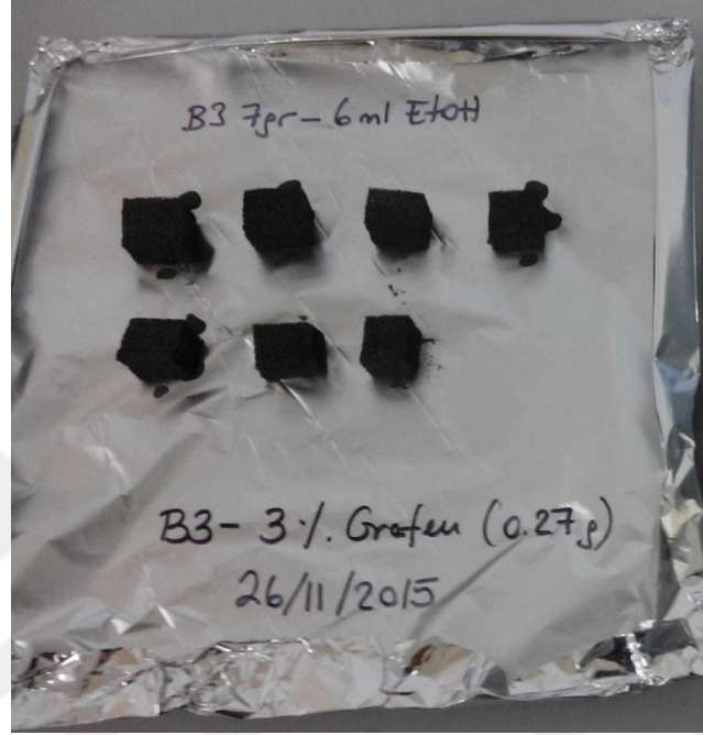
Şekil 3.4. Sinterleme işlemi öncesi kurumaya bırakılan grafen içeren biyoaktif cam skafoldların dijital görüntüleri.
