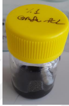
Şekil 3.6. Gözenekli cam skafoldların grafen nanotozları içeren PCL solüsyonuyla kaplanması işlemini gösteren fotoğraf.
