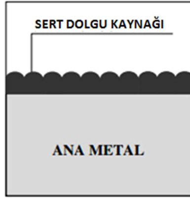
Şekil 1.2. Sert dolgunun parçanın aşınmaya karşı direncinin artırılması [1]
