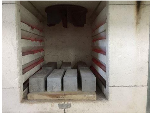
Şekil 5.15. Yüksek sıcaklık fırınına harçların yerleştirme düzeni
