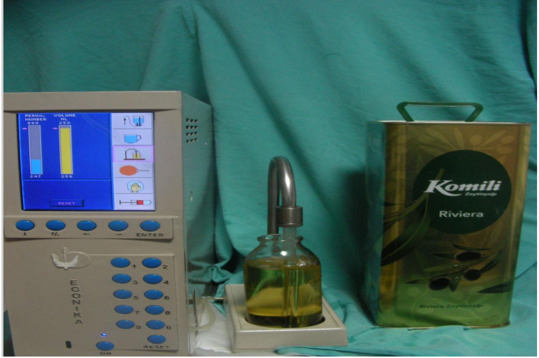
Şekil 17. Ozon üretici makine ve yağlı ozon oluşturma
