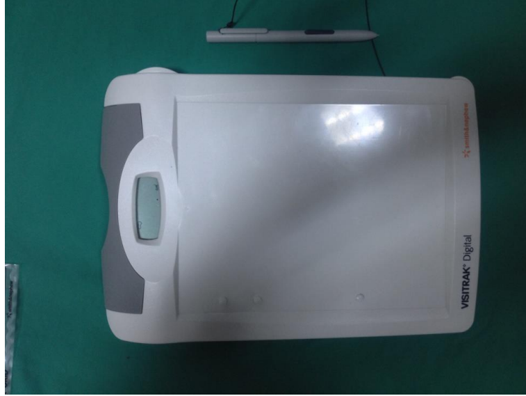
Şekil 10. Flep nekroz alanlarının ölçümü için kullanılan dijital yüzey ölçüm cihazı
