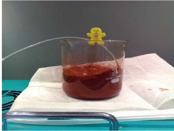
Şekil 3.8. Ham kırmızı çamurun ozon ile aktivasyonu işlemi.
