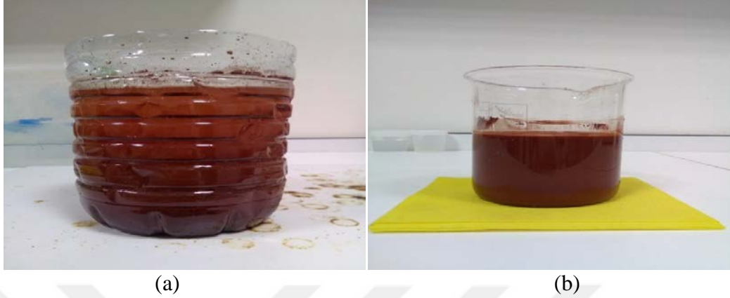
Şekil 3.6. Ham kırmızı çamur yıkama işlemi (a), (b).
