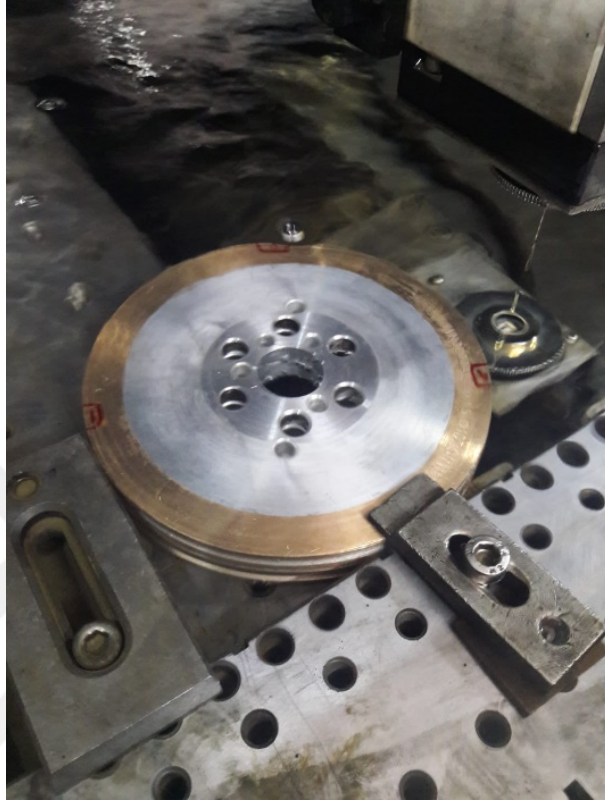
Şekil 5.6. Tel erozyon makinasında disklerin kesim işlemi.
