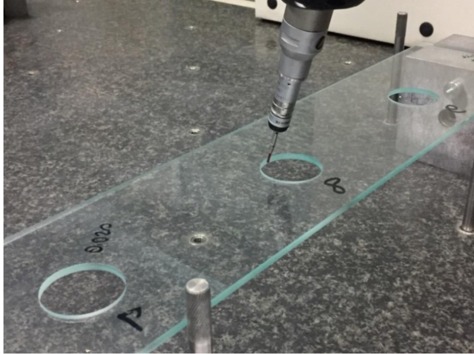
Şekil 5.8a. Prob ucun delik yüzeyine teması (Renishaw Ph10m).
