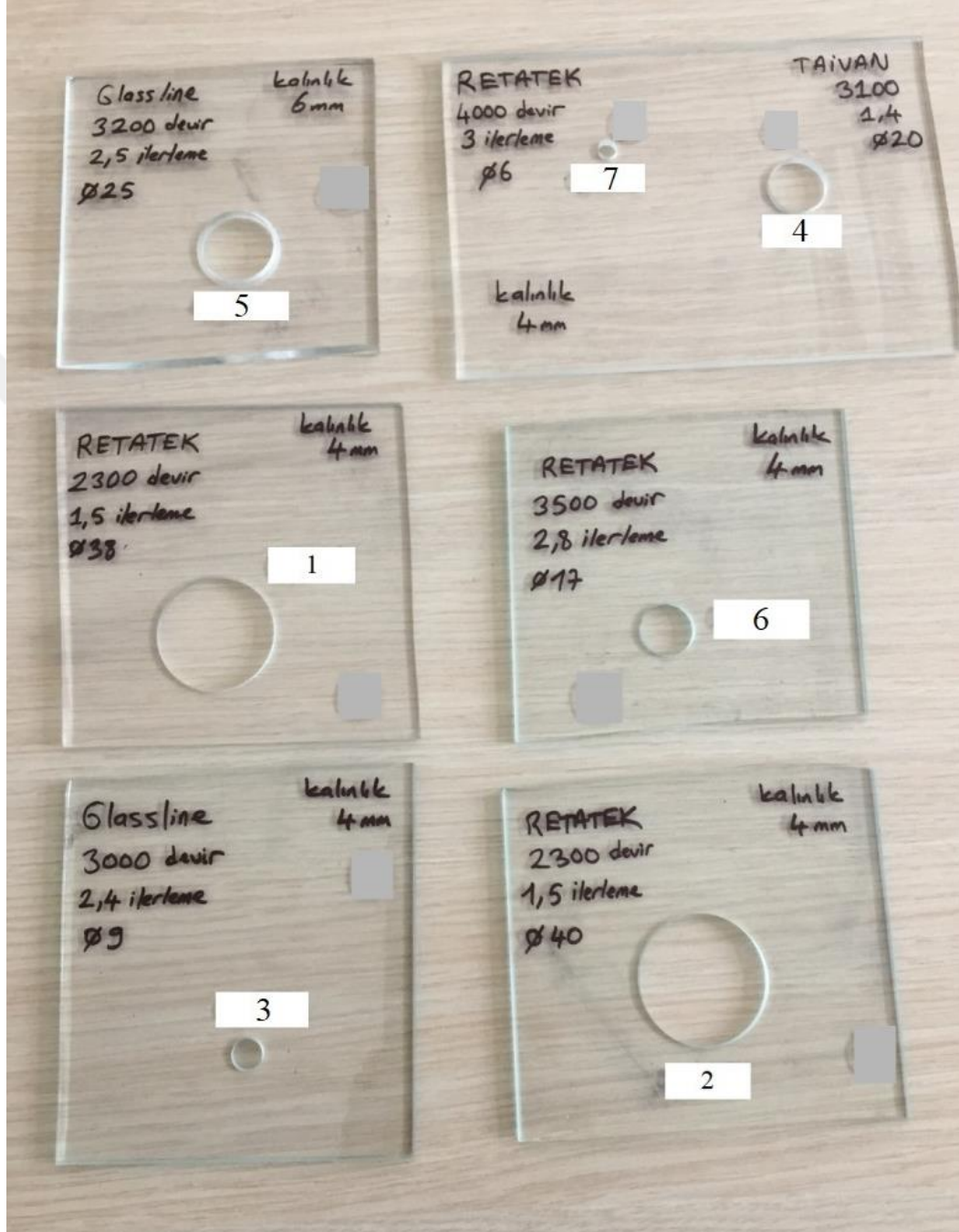
Şekil 5.3. Düz cam için farklı matkap çapları kullanılarak elde edilen deney numuneleri.
