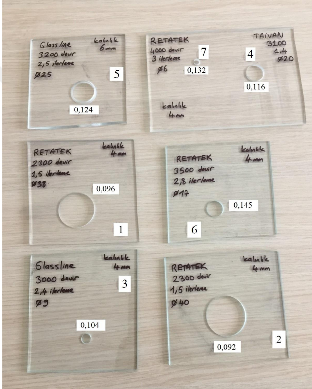
Şekil 6.5. Düz cam için farklı matkap çapları kullanılarak elde edilen deney sonuçları.
