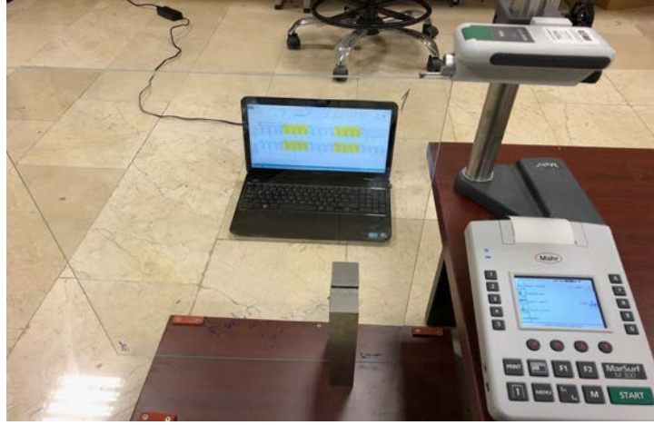
Şekil 5.11. Marsurf M 300 ölçüm cihazı ile pürüzlülük ölçümü.
