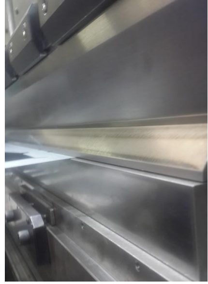
Şekil 2. 12. Dar açılı bükümü ve katlama prosesini gerçekleştiren kalıp.
