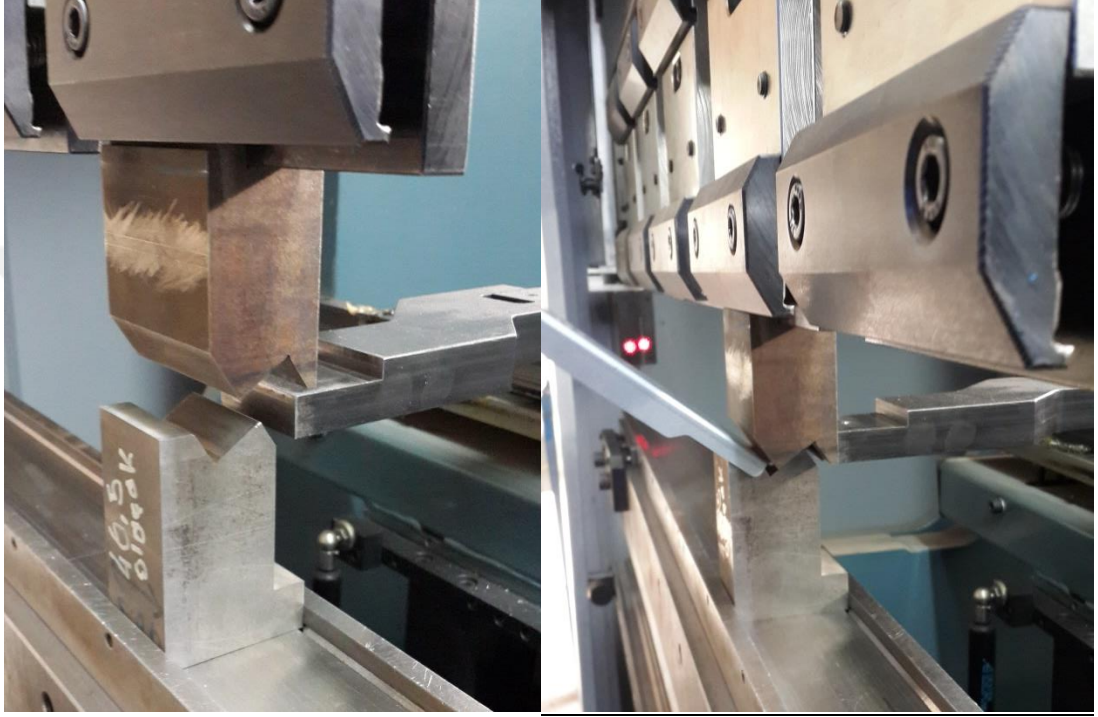
Şekil 2. 7. 90^\circ lik iki bükme işleminin aynı anda uygulanması (Ofset Bükme).
