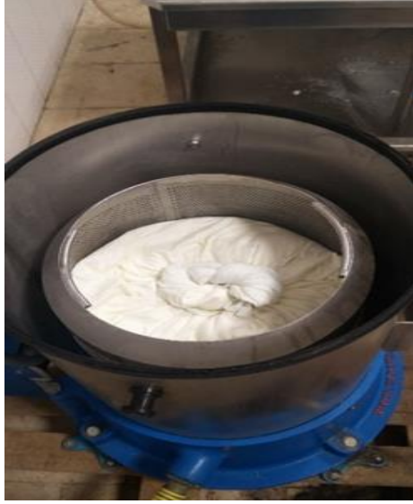
Şekil 3.1. Telemenin santrifüj edilmesi.
