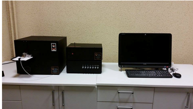
Şekil 3.5. Sunset Termal/Optik OK/EK Analizörü.
