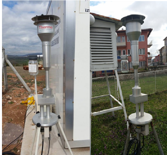
Şekil 3.4. Kentsel ve kırsal istasyonlarda kullanılan dichotomous örnekleyiciler.
