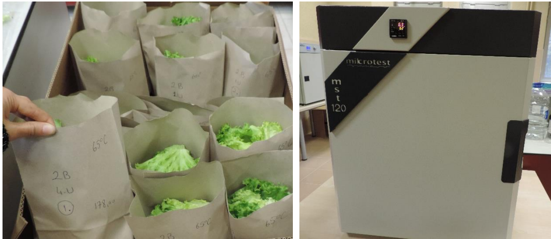
Şekil 3.12. Bitki kuru ağırlığını belirlemek amacıyla örneklerin kese kâğıtlarına konulması ve etüvde kurutulması.
