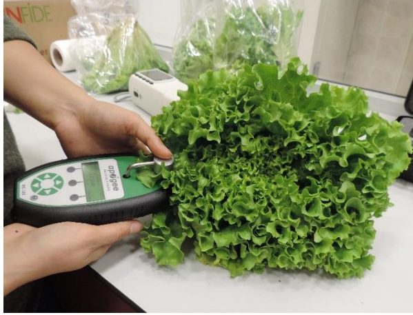
Şekil 3.24. Klorofil miktarının ölçümü.
