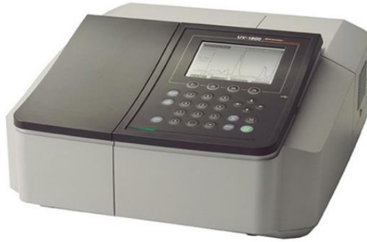
Şekil 3.25. Nitrat tayini için kullanılan UV-visible spektrofotometre cihazı.
