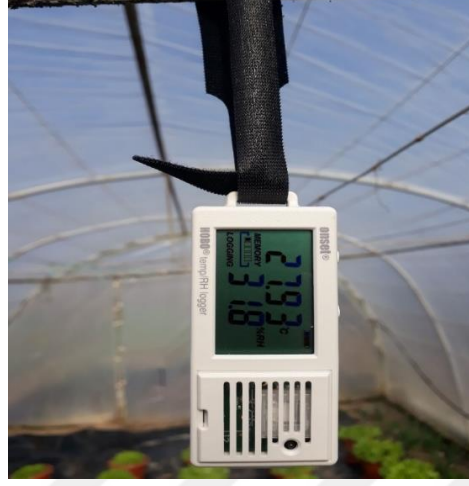
Şekil 3.8. Çalışmada kullanılan sıcaklık ve nem kayıt cihazı.
