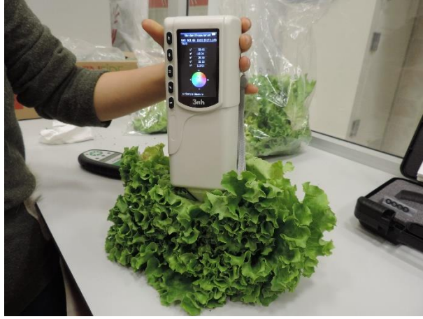
Şekil 3.22. Yaprak renginin ölçümü.
