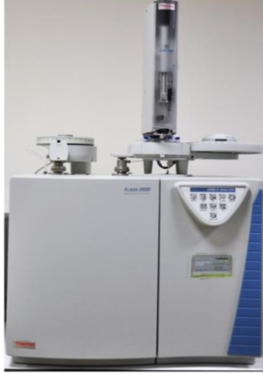
Şekil 3.29. Toplam azot ve toplam kükürt tayini için kullanılan elemental analiz cihazı.
