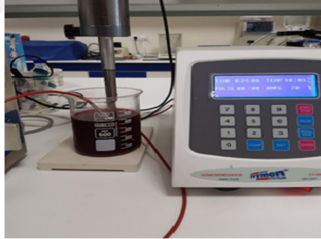
Şekil 3.5. Ultrasonikasyon ile proses edilen şalgam suyu örneği
