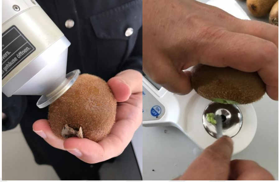
Şekil 3.10. Meyve rengi ve SÇKM ölçümü.
