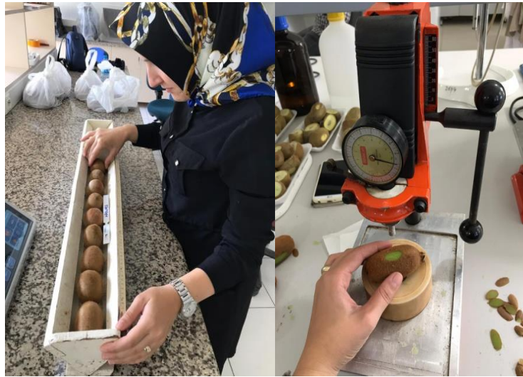
Şekil 3.9. Meyve boyutları ve meyve eti sertliği ölçümü.
