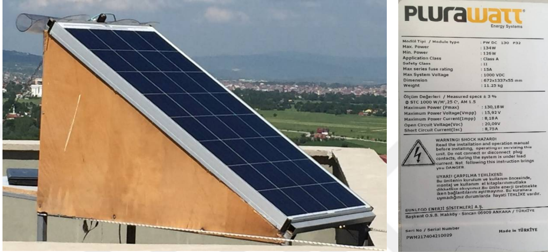
Şekil 4.2. Deneylerde Kullanılan Fotovoltaik Panel ve Panel Etiketleri.
