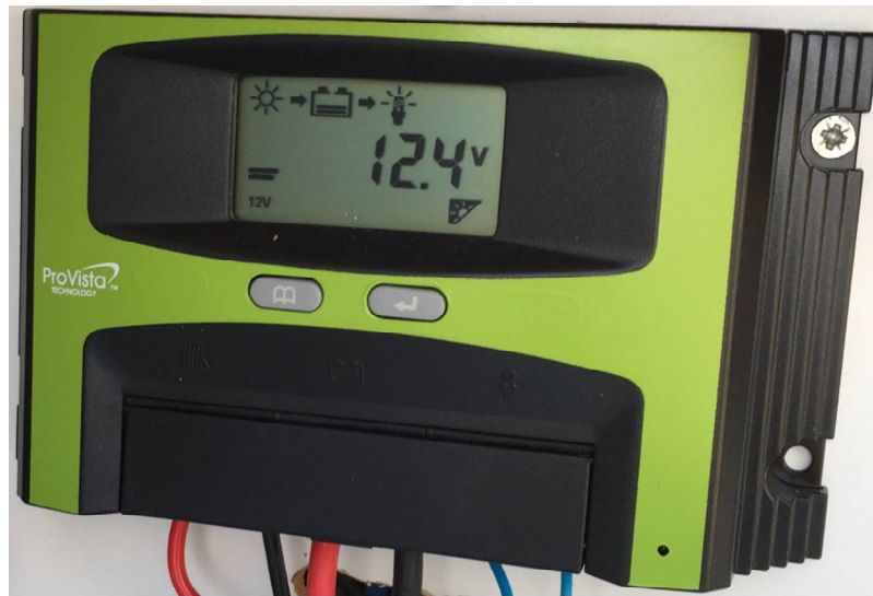
Şekil 4.3. Deneylerde Kullanılan Şarj Regülatörü.
