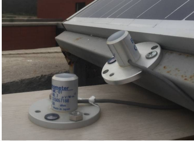
Şekil 4.4. Deney Düzeneğinde Kullanılan Piranometreler (Eko ML-01).
