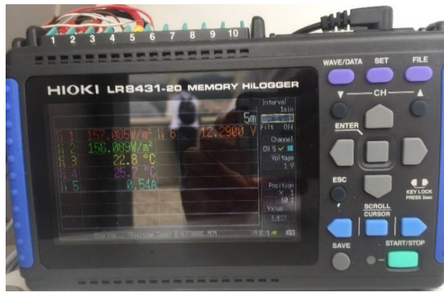
Şekil 4.5. Deney Düzeneğinde Kullanılan Veri Kayıt Cihazı (Data Logger).
