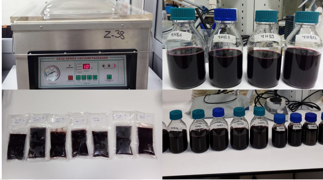
Şekil 3.3. Yüksek hidrostatik basınç uygulamalarına ilişkin numunelerin ambalajlanması, vakum paketlenmesi ve proses sonrası analizler için hazırlanmasına ilişkin görseller.
