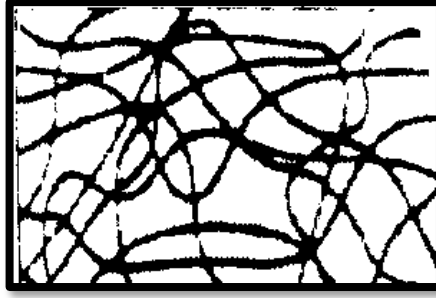
Şekil 1.1. Termoplastiklerin molekül yapısı (Güngör, 2001).
