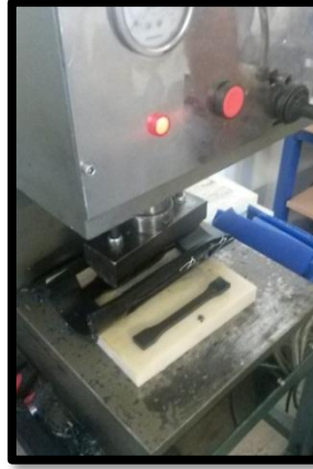
Şekil 4.5. Borudan numune kesme işlemi.
