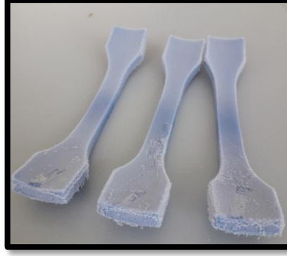
Şekil 4.12. Sıvı azot içerisinde bekletilmiş çekme numunesi.
