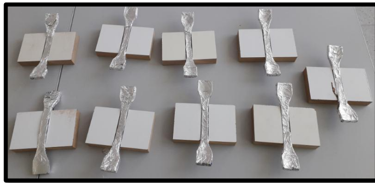
Şekil 4.9. Fırında erime sıcaklığı üzerinde ( 150^{\circ}\text{C} ) bekletilecek numunelerin hazırlanması.
