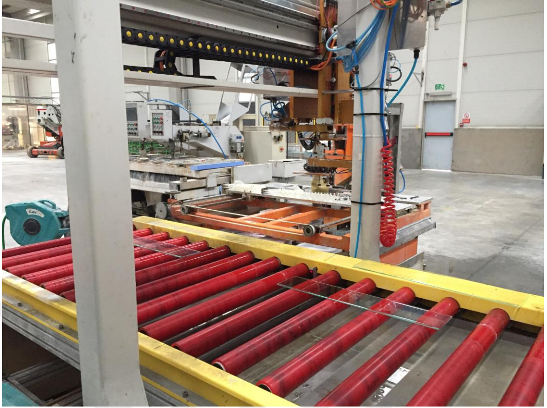
Şekil 5.3. Camın delinmek üzere makineye verilmesi.
