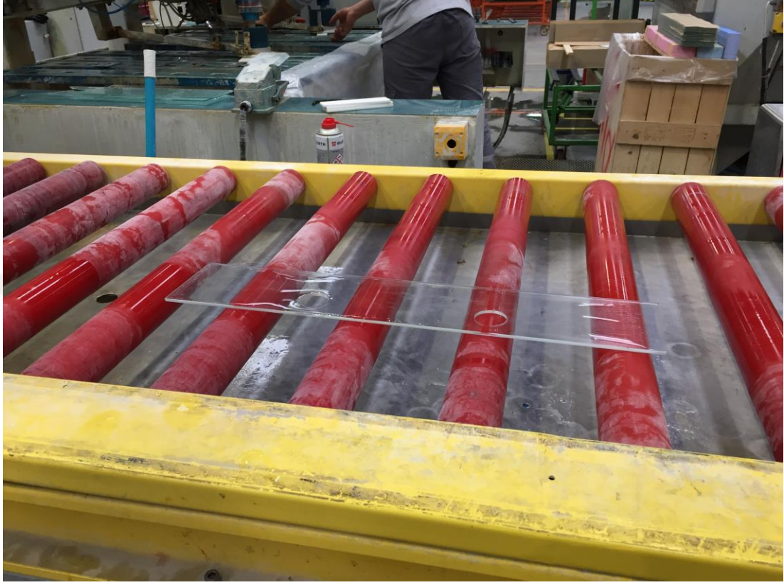
Şekil 5.6. Delinen camların konveyörde ilerlemesi.
