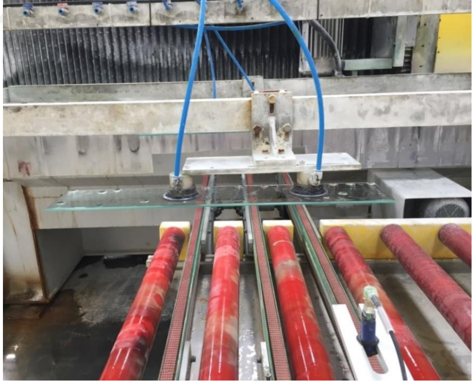
Şekil 5.5. Camın vakumlanarak taşınması.
