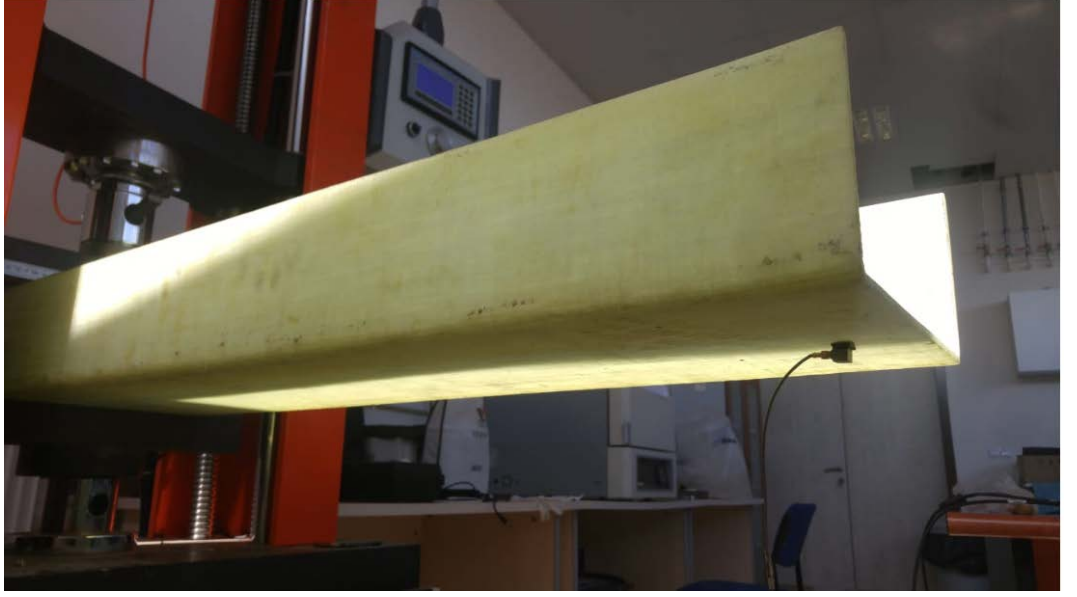
Şekil 4.7. İvmeölçer'in U profil kiriş üzerindeki konumu
