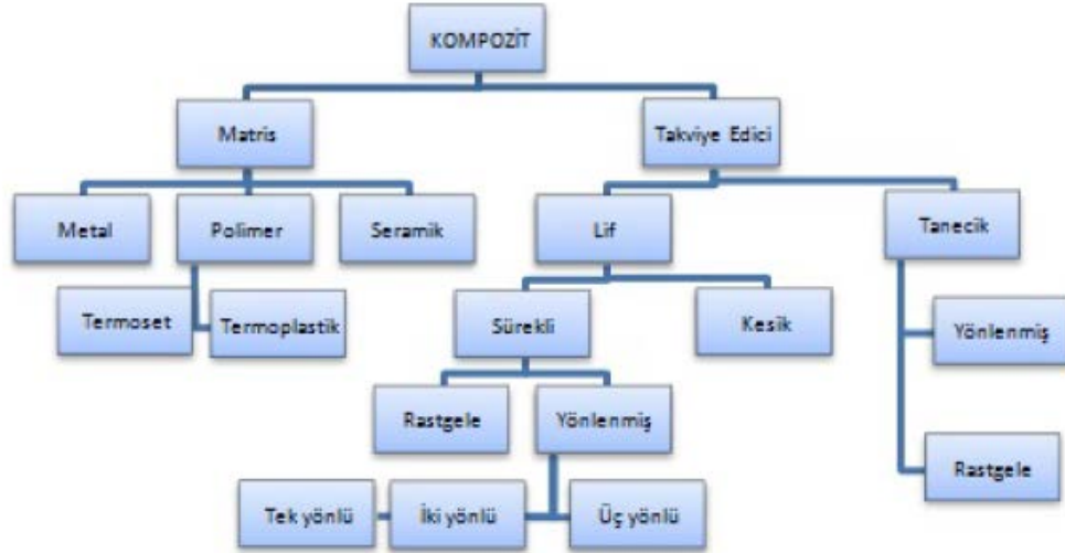
Şekil 2.3. Kompozitlerin Matris ve Takviye Elemanlarına Göre Gruplandırılması (Aydın, 2018)
