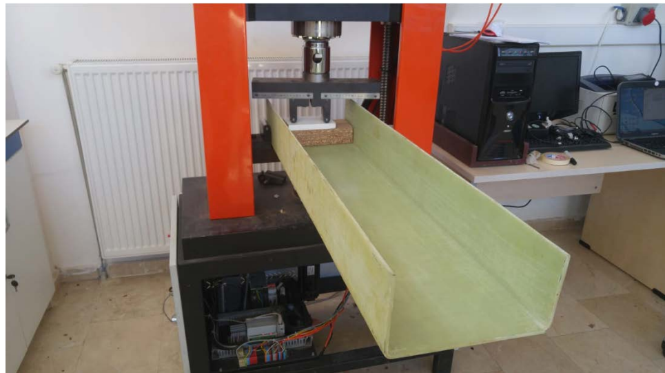
Şekil 4.6. Bir ucundan ankastre edilmiş 8 tabakalı kompozit U profil kiriş
