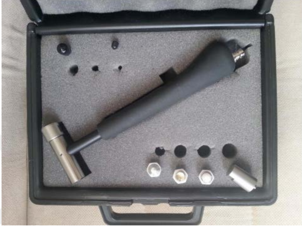
Şekil 4.3. Titreşim ölçümünde kullanılan Brüel&Kjaer marka darbe çekici
