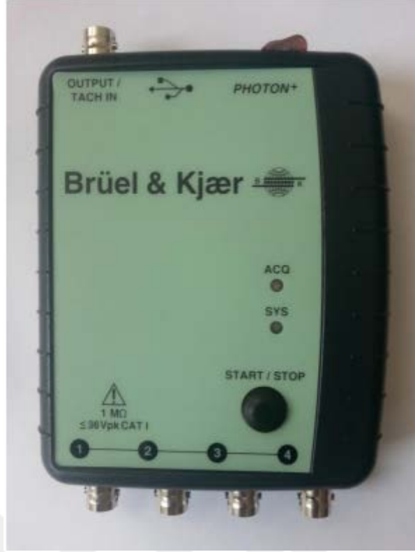
Şekil 4.4. Brüel Kjaer PHOTON+ sinyal şartlandırıcı
