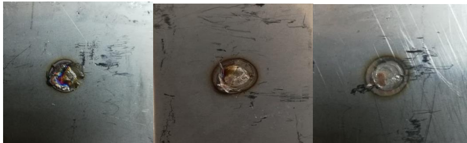
Şekil 7.15. CuCrZr elektrodu kullanılarak, 5,4 kA akım ve 2 bar sabit elektrot kuvvetinde 5(solda), 10(ortada), 15(sağda) çevrimde yapılan soğutmalı kaynaklı numunelerin çekirdek görünümü.
