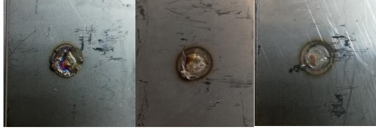
Şekil 7.25. CuCrZr elektrodu kullanılarak, 5,4 kA kaynak akımı ve 2 bar sabit elektrot kuvvetinde 5(solda), 10(ortada), 15(sağda) çevrim kaynak zamanında yapılan soğutmalı kaynaklı numunelerin kaynak çekirdeğinin görünümü.
