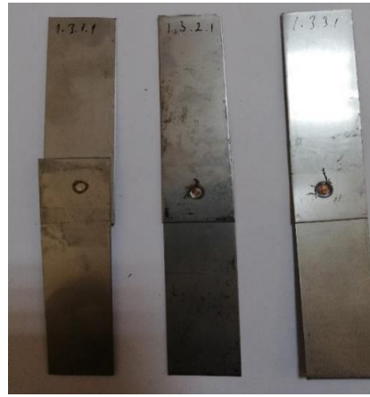
Şekil 7.13. CuCrZr elektrodu kullanılarak, 5,4 kA akım ve 2 bar sabit elektrot kuvvetinde yapılan soğutmasız kaynaklı numuneler (5(sol), 10(orta), 15 (sağ) çevrim).
