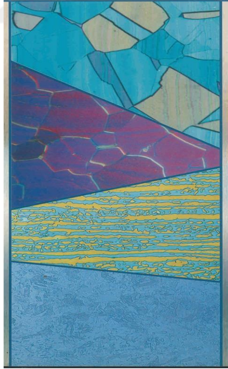
Şekil 5.1. Paslanmaz çelik türlerinin iç yapıları (Aran ve Temel, 2004).
