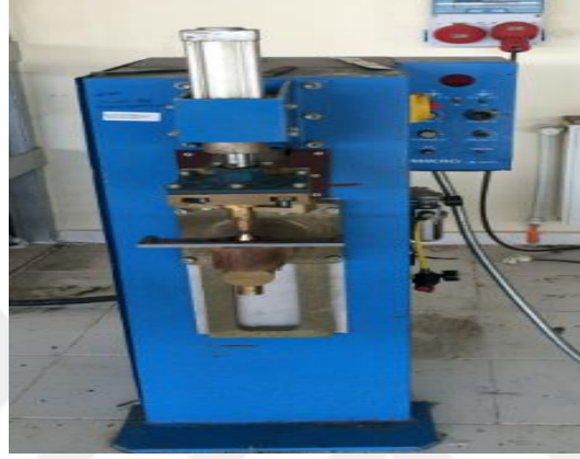
Şekil 6.1. Kaynak çalışmalarında kullanılan geleneksel nokta kaynak makinesi.
