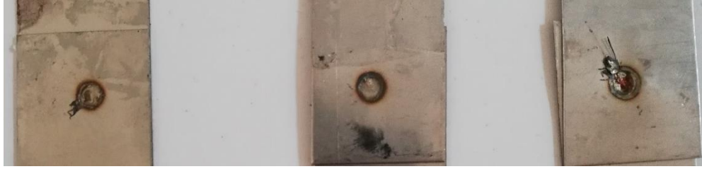
Şekil 7.21. CuCrZr elektrodu kullanılarak soğutmasız, 15 çevrim ve 4 bar elektrot baskı kuvvetinde artan kaynak akımındaki çekirdek görünümleri (sol 3,4 kA, orta 4,4 kA, sağ 5,4 kA)
