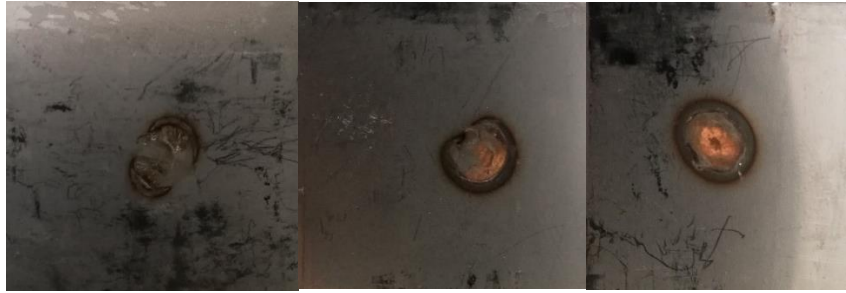
Şekil 7.17. CuCoBe elektrodu kullanılarak, 5,4 kA akım ve 4 bar sabit elektrot kuvvetinde 5(solda), 10(ortada), 15(sağda) çevrimde yapılan soğutmasız kaynaklı numunelerin çekirdek görünümü.
