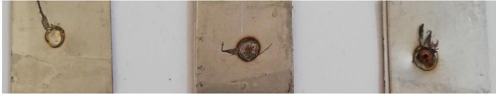
Şekil 7.30. CuCrZr elektrodu kullanılarak soğutmasız, 5,4 kA kaynak akımı ve 4 bar elektrot baskı kuvvetinde artan kaynak çevriminde çekirdek görünümleri (5(solda), 10(ortada), 15(sağda) çevrim ).
