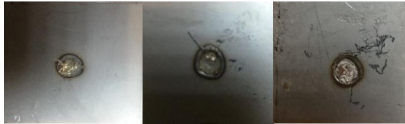
Şekil 7.23. CuCrZr elektrodu kullanılarak, 10 çevrim kaynak zamanı ve 2 bar sabit elektrot kuvvetinde 3,4(solda), 4,4(ortada), 5,4(sağda) kA kaynak akımında yapılan soğutmasız kaynaklı numunelerin kaynak çekirdeğinin görünümü.
