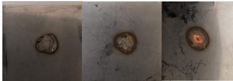
Şekil 7.27. CuCoBe elektrodu kullanılarak, 15 çevrim kaynak zamanı ve 4 bar sabit elektrot kuvvetinde 3,4(solda), 4,4(ortada), 5,4(sağda) kA kaynak akımında yapılan soğutmasız kaynaklı numunelerin kaynak çekirdeğinin görünümü.
