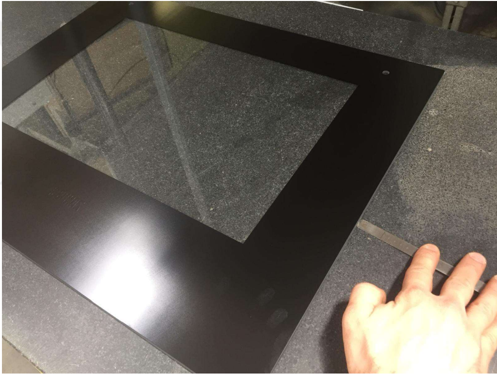
Şekil 6.13. Kamburluk Ölçümünün Gösterimi
