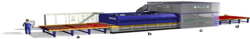
Şekil 4.2. Temperleme Hattı a) Yükleme Tablası b) Isıtma Fırını c) Soğutma Bölümü d) İndirme Tablası (Rantala, 2015)
