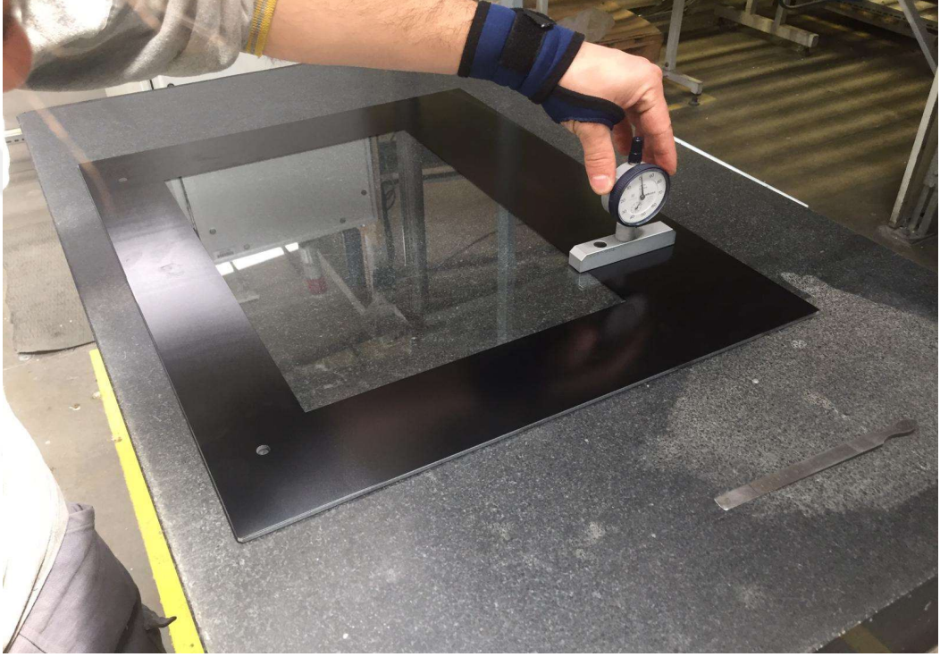
Şekil 6.11. Dalgalılık Ölçümünün Gösterimi
