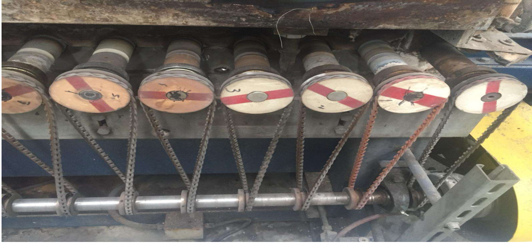
Şekil 6.5. Fırın Hareket Mekanizması
