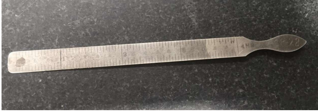
Şekil 6.12. Kamburluk Ölçümü İçin Kullanılan Dereceli Filler Çakısı
