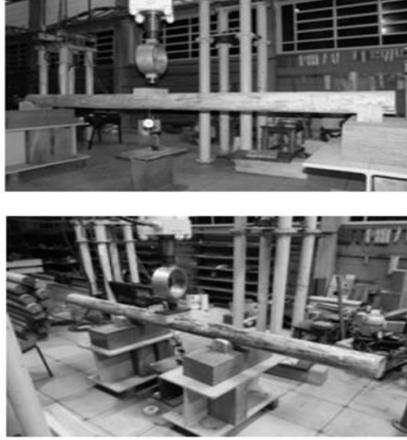
Şekil 5.5. Yuvarlak ahşap parçaların 3 nokta eğme testi görüntüsü (Andre vd.,)
