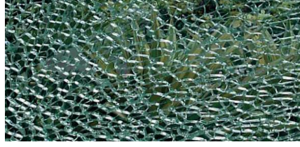
Şekil 4.7. Temperli cam ( Kırılma Görüntüsü) (Ungan).
