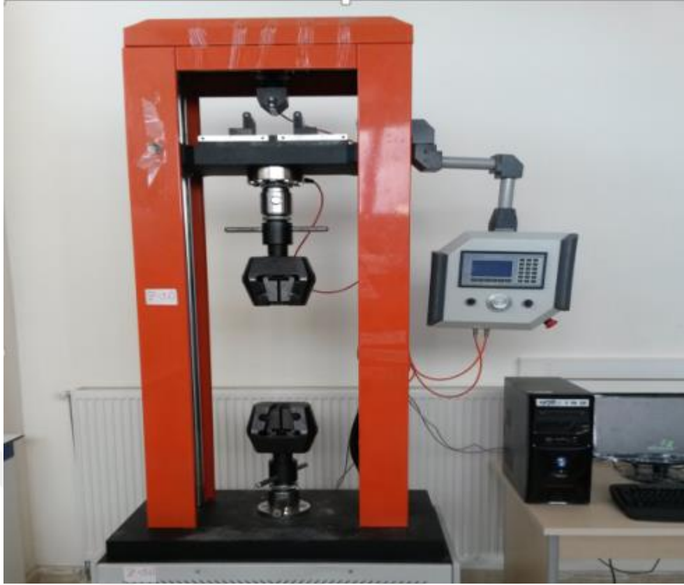
Şekil 6.2. ELISTA Marka EMB 400-400 kN Model Çekme Cihazının Görüntüsü
