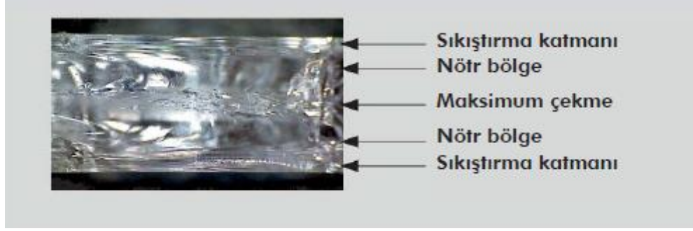
Şekil 4.4 Temperli camın yan kesit görünüşü (Barr, 2005).
