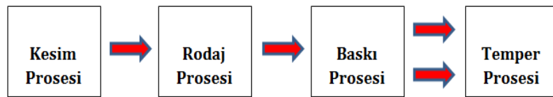
Şekil 4.8. Cam üretim proses şeması
