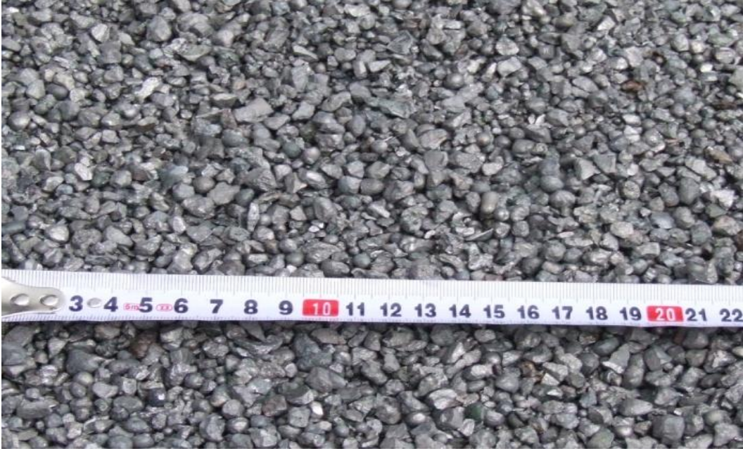
Şekil 5.1 -6+1 mm toplu konsantre numunesi.
