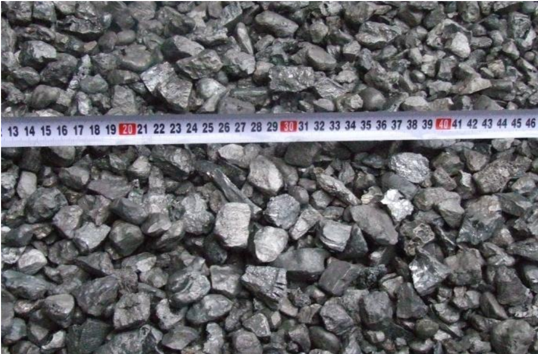
Şekil 5.2 -30+6 mm toplu konsantre numunesi.
