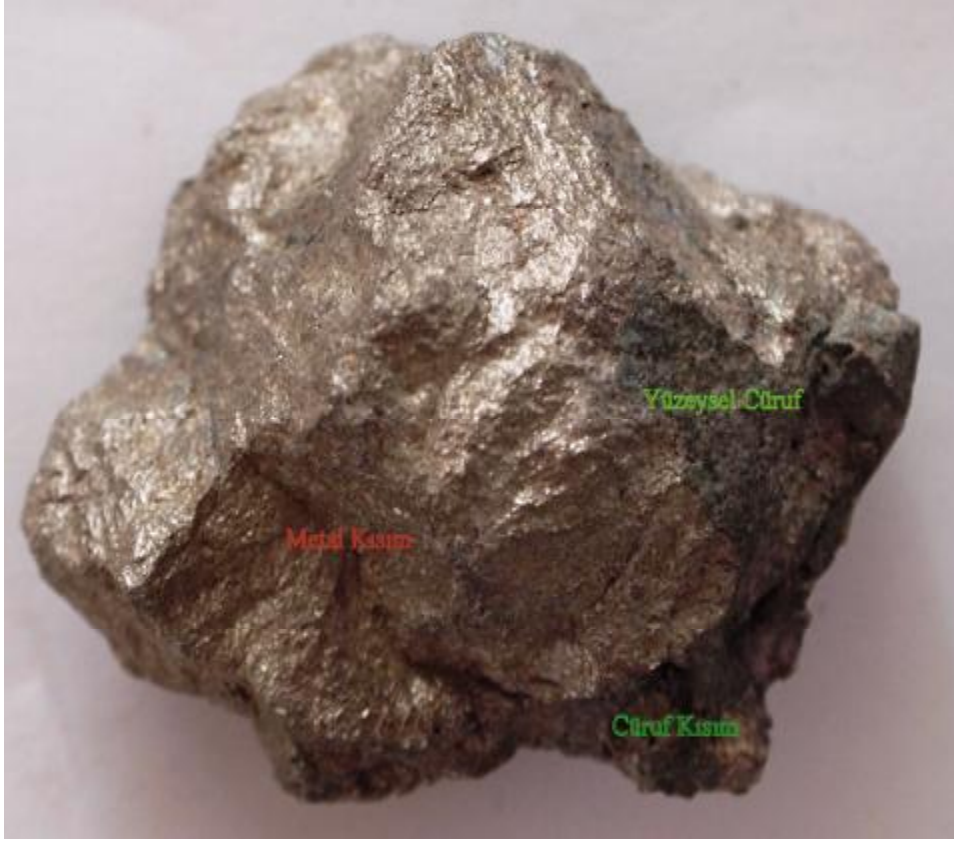
Şekil 5.11 -30+6 mm Oluk-1 ara ürün görüntüsü.
