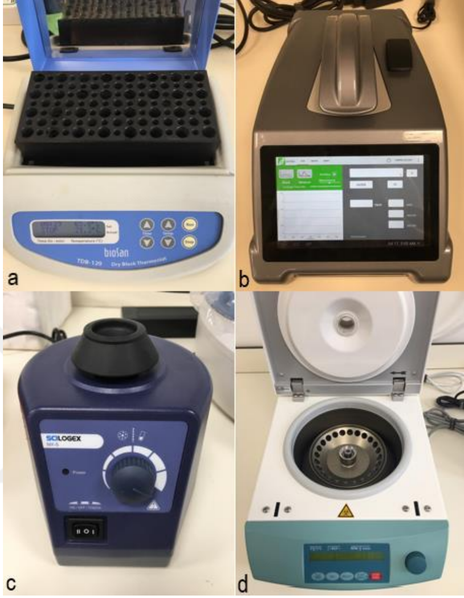
Şekil 3.2.3.1 DNA izolasyonu işlemlerinde kullanılan bazı cihazlar (a. Kuru blok ısıtıcı b. Spektrofotometre c. Vortex d. Santrifüj)
