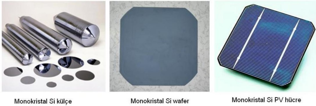
Şekil 2.9. Monokristal FV Hücresi.
