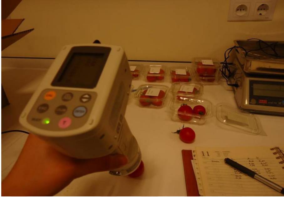
Şekil 3.3 Domates yüzeyi renk ölçümü ve renk ölçüm cihazı.
