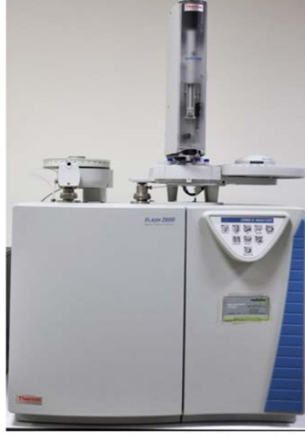
Şekil 3.31. Toplam azot ve toplam kükürt tayini için kullanılan elemental analiz cihazı.
