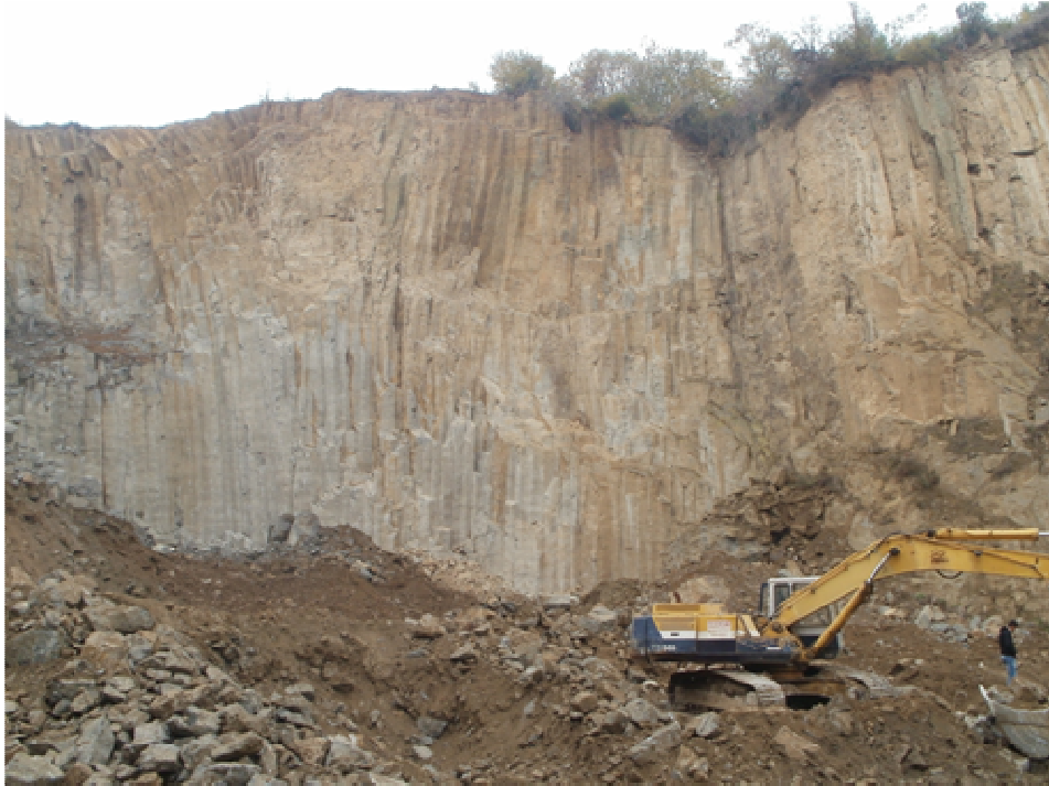
b. Andezit retim aynası.
