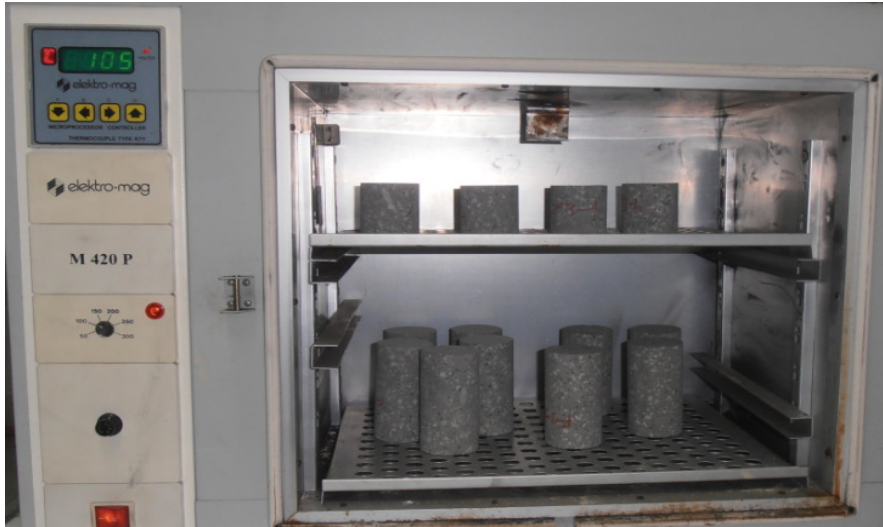
Şekil 5.6 Kuru durum için etüvde 105°C'de 24 saat süresince kaya örneklerinin kurutulması.
