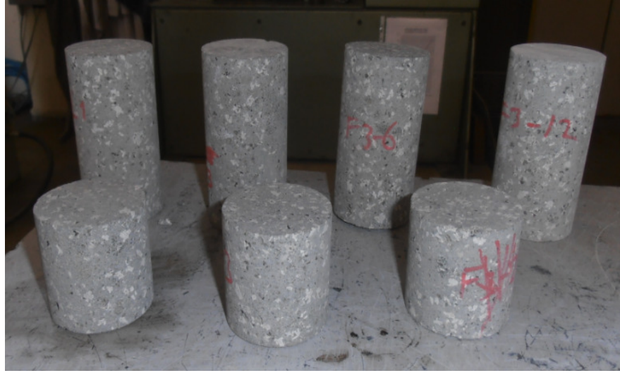
Şekil 5.4 Farklı yükseklik/çap oranlarına sahip andezit örneklerine ait görünüm.
