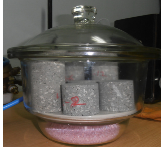
Şekil 5.7 Fırında kurutulan kaya örneklerinin nemden korunması için desikatör kullanımı.
