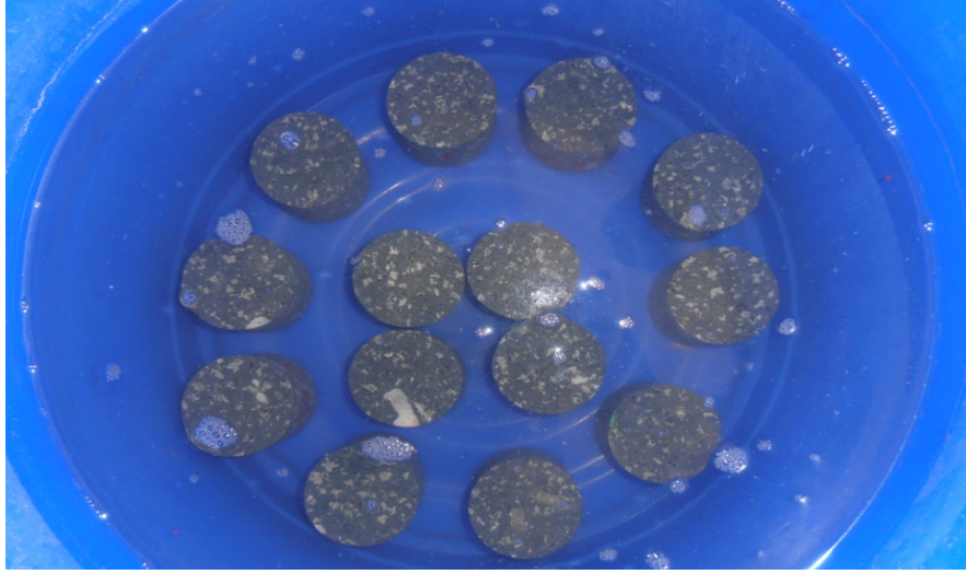
Şekil 5.5 Suya doymun durum için kaya örneklerinin 48 saat süresince suda bekletilmesi.
