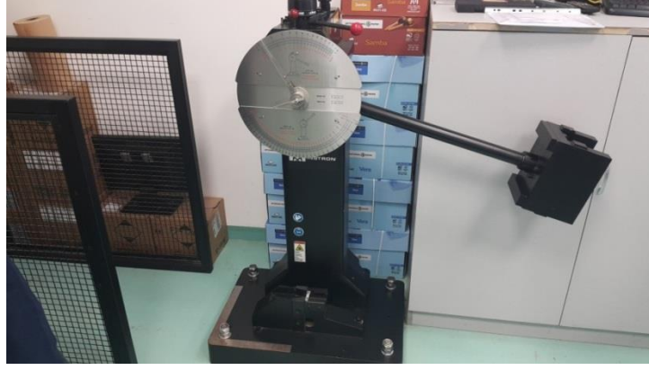
Şekil 6.16. Kaynak numunesinin çentik darbe deneyi yapılması sırasında bir fotoğraf
