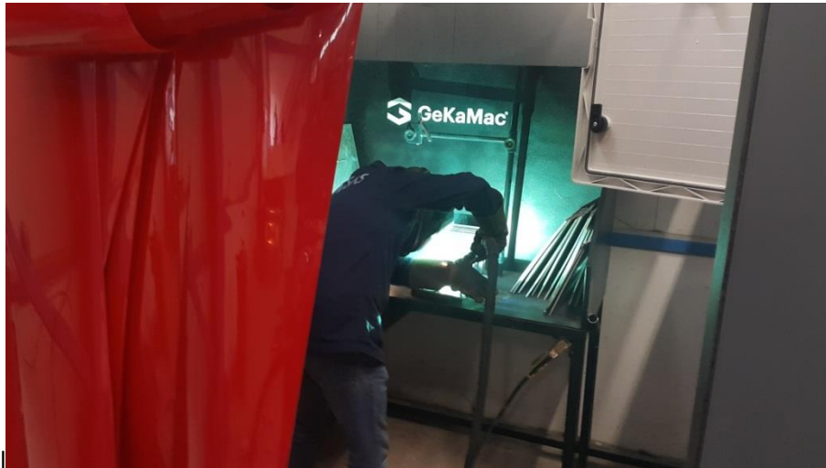
Şekil 5.2. Alüminyum deney numunelerinin MIG ile kaynak yapılması
