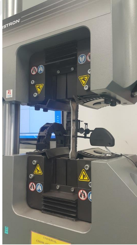
Şekil 6.1. Kaynak numunesinin çekme deneyi yapılması sırasında bir fotoğraf
