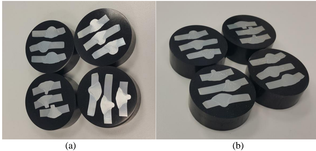
Şekil 6.19. Makro Vickers sertlik numuneleri a) deney öncesi, b) deney sonrası
