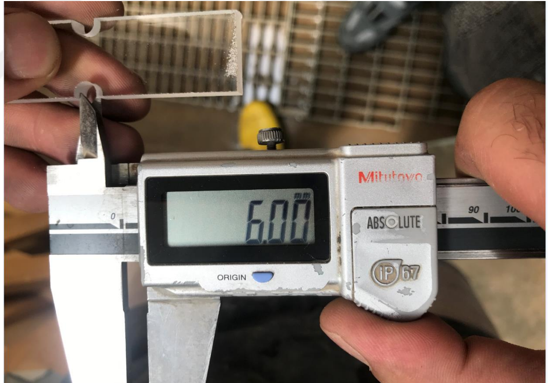
Şekil 4.7. Kesilen Örnek Numunelerde Ölçü Kontrollerinin Yapılması.
