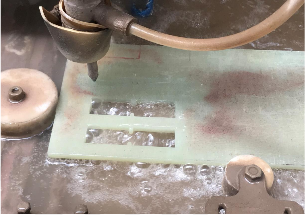
Şekil 4.10. Aşındırıcı Su Jeti ile Numunelerin Kesilmesi.
