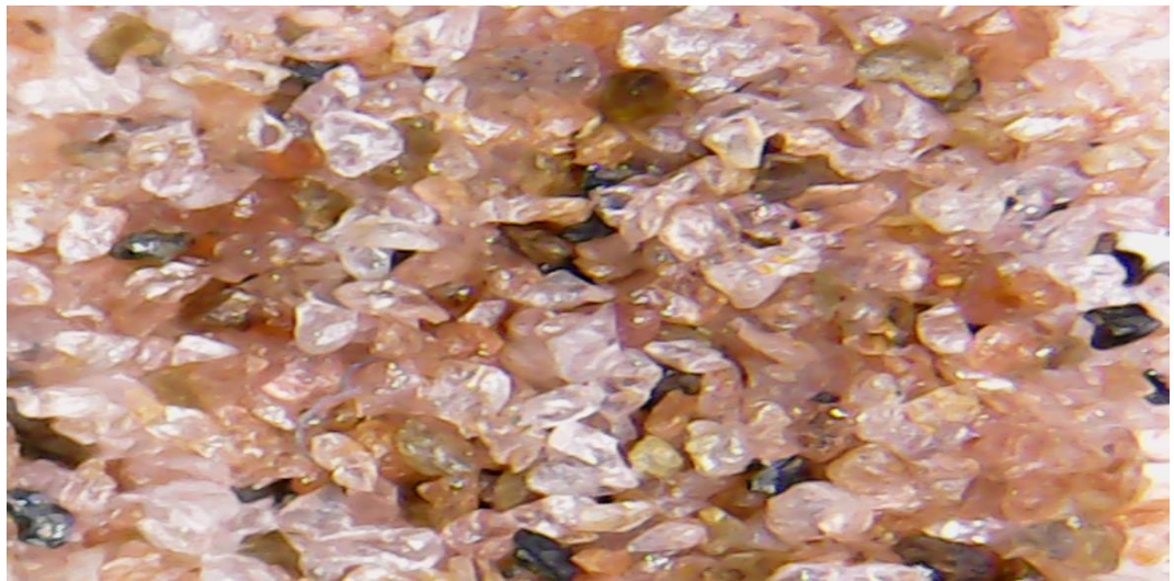
Şekil 4.9. Kumun Mikroskop Altındaki Görüntüsü (12X büyütülmüş görüntü).
