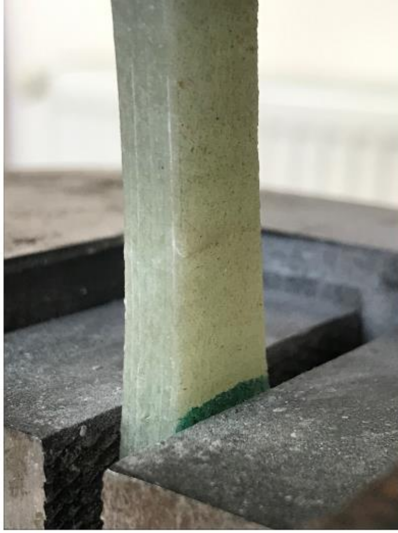
Şekil 5.3. Yorulma Deneyi Sırasında Çentiksiz Numunede Başlayan Hasar (DeneySEL).
