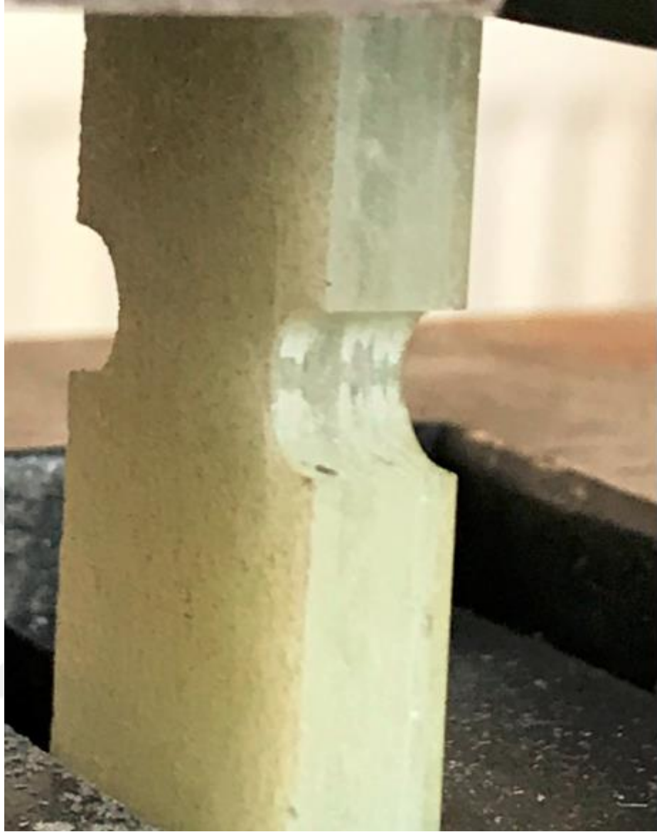
Şekil 5.2 Yorulma Deneyi Sırasında Çentikte Başlayan Hasar (Deneysel).
