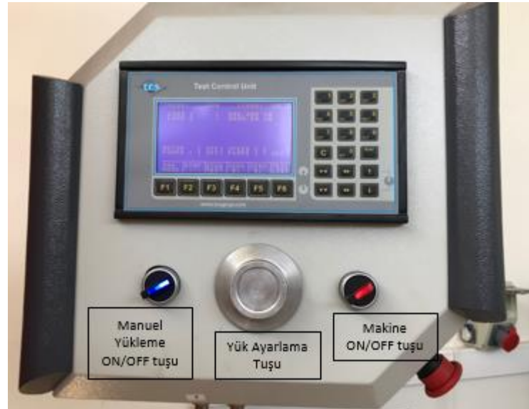
Şekil 4.17. Makine Kontrol Paneli ve Düğmelerin Gösterimi.
