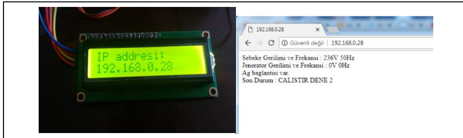
Şekil 7.4. Modülün modemden aldığı IP adresi ve elde edilen veriler.
