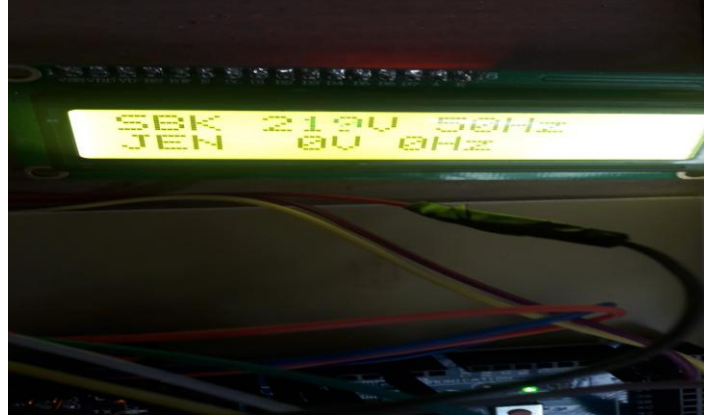
Şekil 6.9. Sistemin şebeke üzerindeki okumuş olduğu değeri yazdırması.
