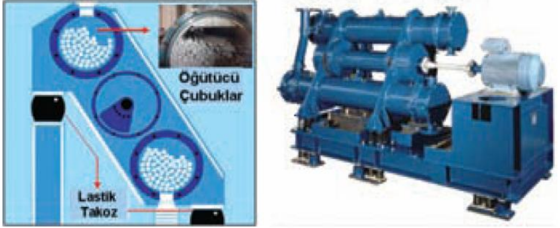
Şekil 3.8 Titreşimli değirmen ve kesit görünüşü (Hacıfazlıoğlu 2009).
