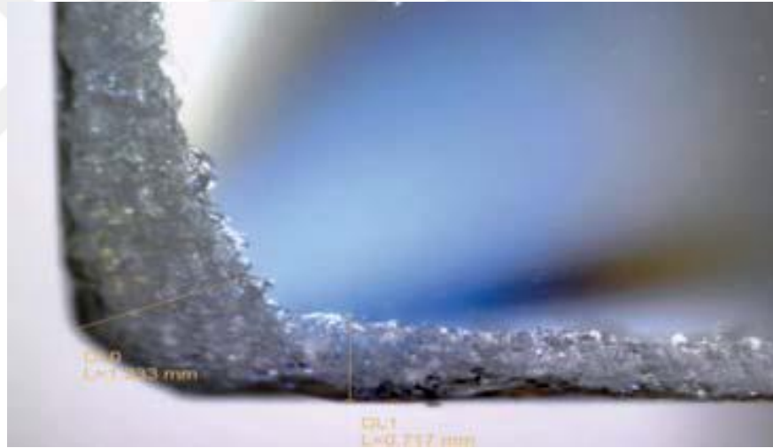
Şekil 4.8. Kötü Yapılmış Zımpara Örneği ( http://www.yorsancam.com/wp-content/uploads/2015/01/temper.pdf ).
