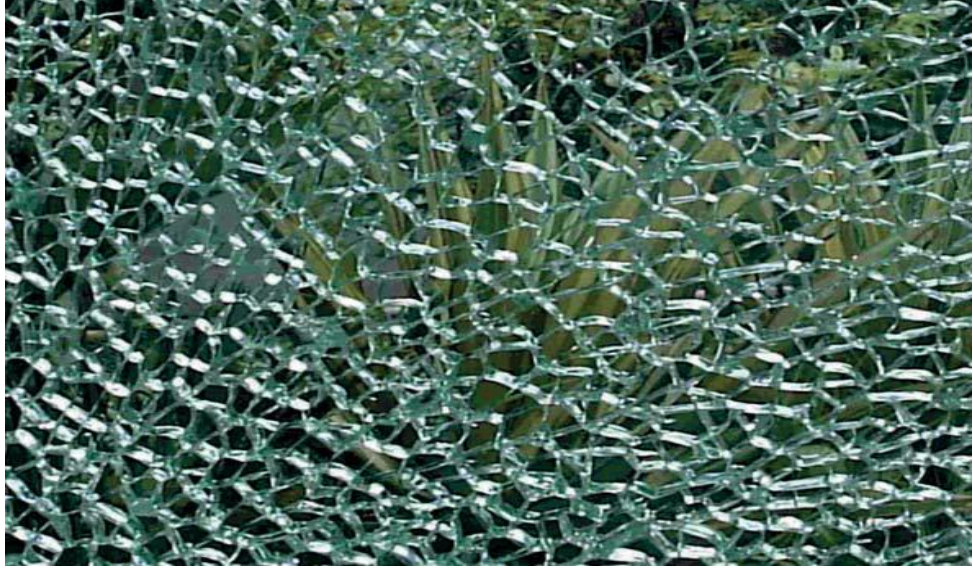
Şekil 4.23. Temperli Cam (tipik kırılma) ( http://www.yorsancam.com/wp-content/uploads/2015/01/temper.pdf ).
