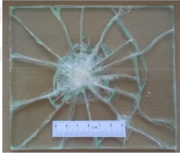
Şekil 4.22. Temperlenmemiş Camda Kırılma (Akçay vd., 2016, s. 1063).
