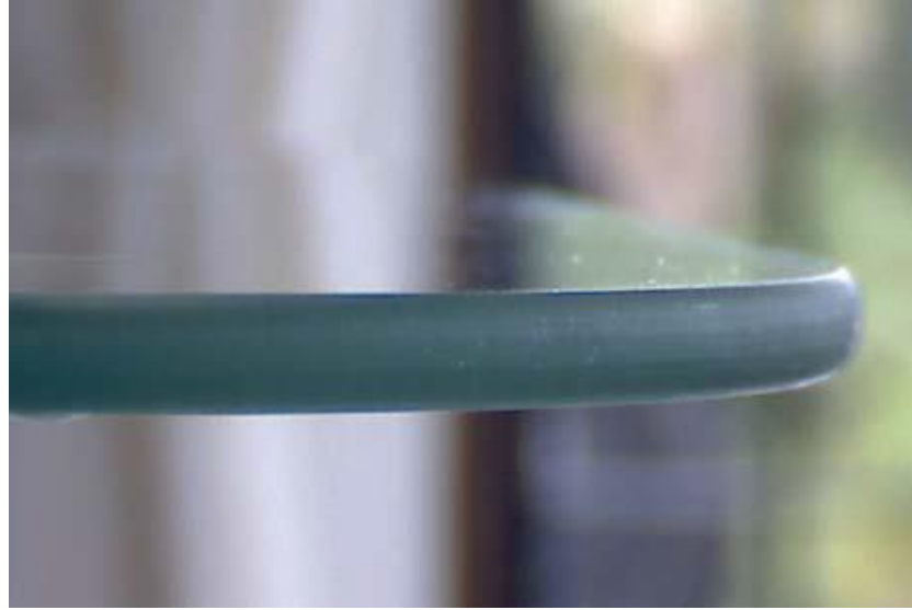
Şekil 4.7. İyi Yapılmış Bir Rodajlama Örneği ( http://www.yorsancam.com/wp-content/uploads/2015/01/temper.pdf ).
