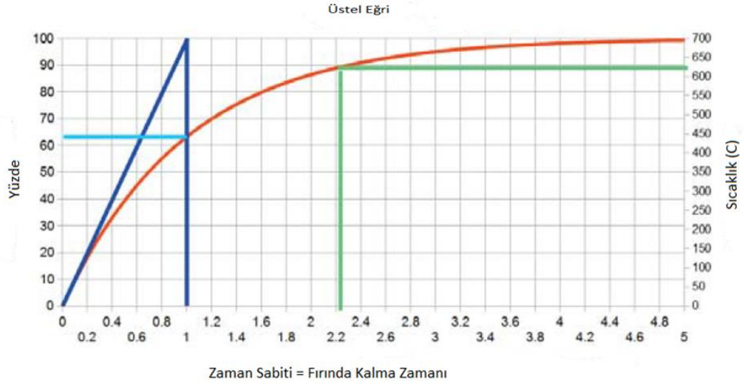
Şekil 4.12. Camın Fırın İçinde Isınma Hızı ( http://www.yorsancam.com/wp-content/uploads/2015/01/temper.pdf ).
