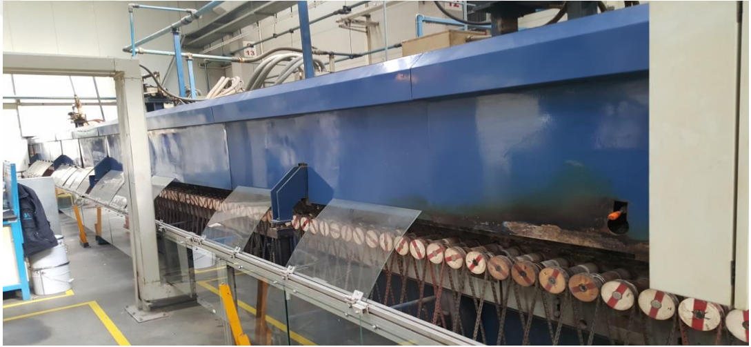
Şekil 5.3. Fırındaki Hareket Mekanizması
