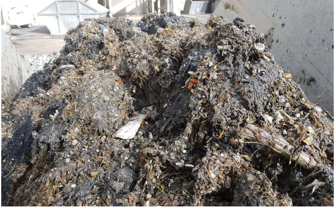
Şekil 1.13. Ön arıtma ünitesinden çıkan elüktü malzeme.
